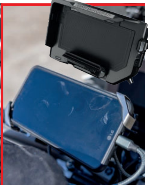
Der BMW Navigator kam öfter zum Einsatz als die Connected App. Mit dem ConnectedRide Cradle bietet BMW seit Kurzem eine werksseitige Smartphone-Ladehalterung für den Sockel des Navigationsgeräts an
