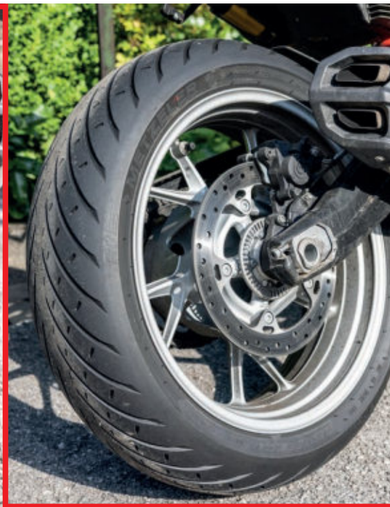
Der Bridgestone T32 (links) steigert den Fahrkomfort und passt besser zum sportlichen Charakter der BMW F 900 XR als der Metzeler Roadtec 01 SE, der bei vergleichbarem Nassgrip höhere Laufleistungen meistert
