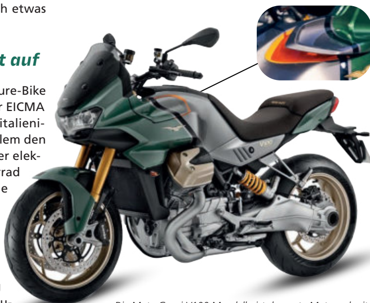
Die Moto Guzzi V100 Mandello ist das erste Motorrad mit adaptiver Aerodynamik. Je nach Geschwindigkeit und Fahrmodus recken sich Deflektoren an den Seiten des Tanks in den Fahrtwind.
