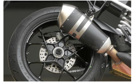
Einarmschwinge und ungewohnt kurzer Endtopf. Möglich macht das ein fetter Vorschalldämpfer (Spitzname Brotkasten)
