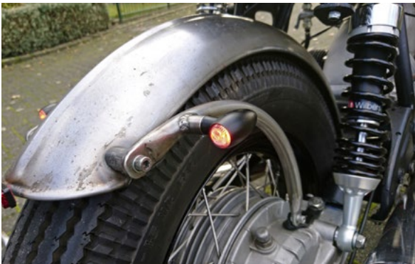
Vieles entstand in Handarbeit, wie diese Halterung
