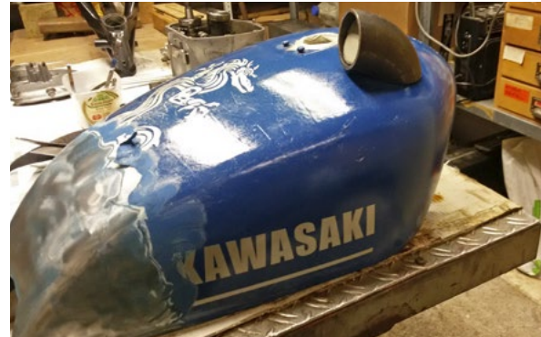
Halterungen und Öffnungen neu, Dellen raus
