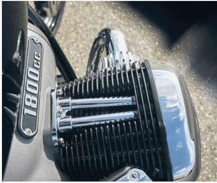
Augenschmaus: Die Hüllrohre der Stößelstangen und Ventildeckel sind verchromt.
