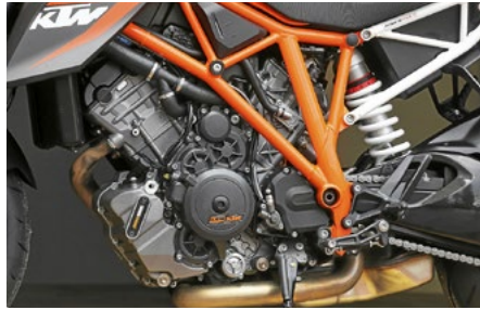
Der 1301-Kubik-V2 hängt in tragender Funktion im hübschen Gitterrohrrahmen, markentypisch in Orange inszeniert
