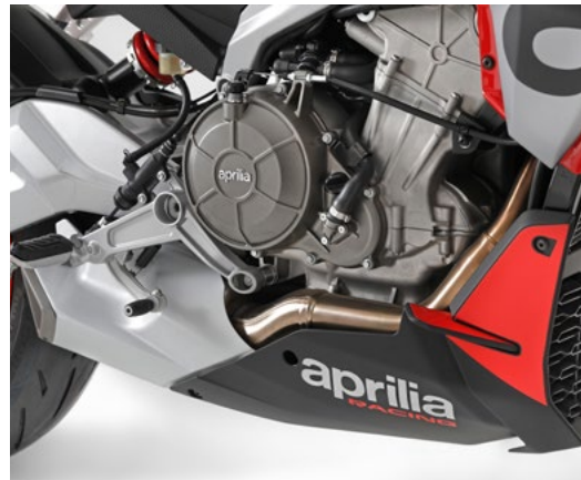
Direkt angelenktes Federbein, bündig integrierter Schalldämpfer, Bananenschwinge
