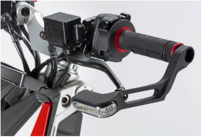
Da muss man draufkommen: Blinker in den Bremshebelschützern
