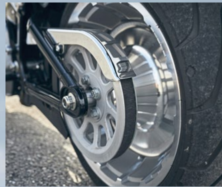
Sauber, leise, leicht und quasi wartungsfrei: Sekundärtrieb via Zahnriemen
