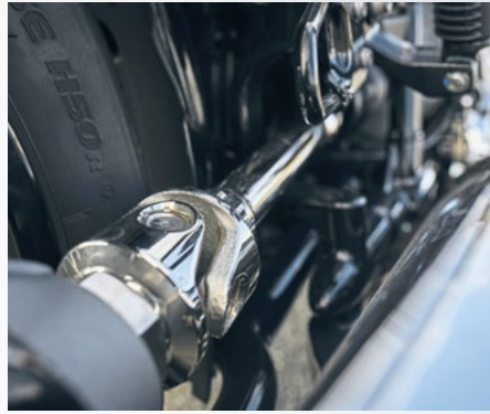
Offen laufender Kardan: Mal schau'n, wann der Zubehörmarkt Abdeckungen anbietet
