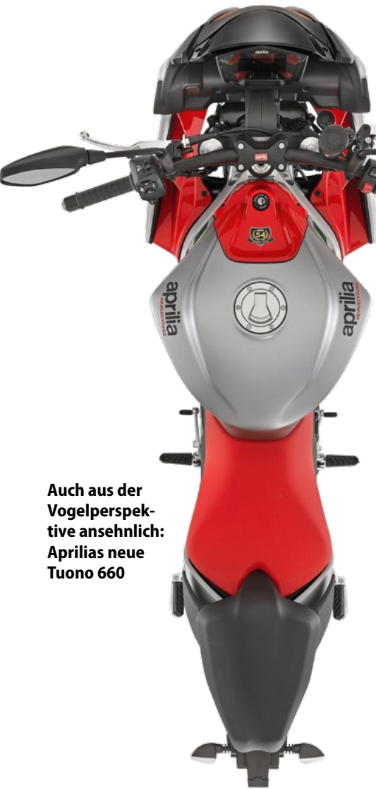
TFT-Display, winzige Scheibe, Dämpfer-einheit in nur einem Gabelholm
