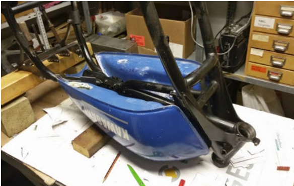
Z-1000-Tank an den Rahmen anpassen: unorthodox
