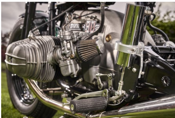
Kliktronic-System: Schaltvorgänge per Knopfdruck
