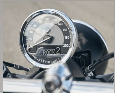
Monolithisches Rundinstrument im Art-Deco-Look mit pixeligem LCD-Abteil
