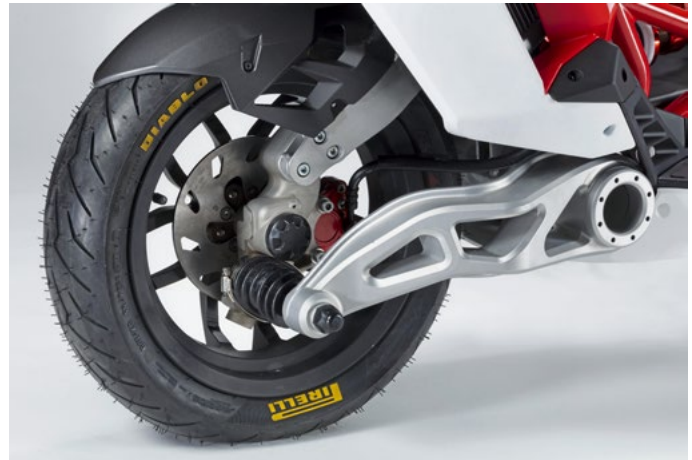
Aufwendig, teuer, aber extrem chic: die Achsschenkellenkung
