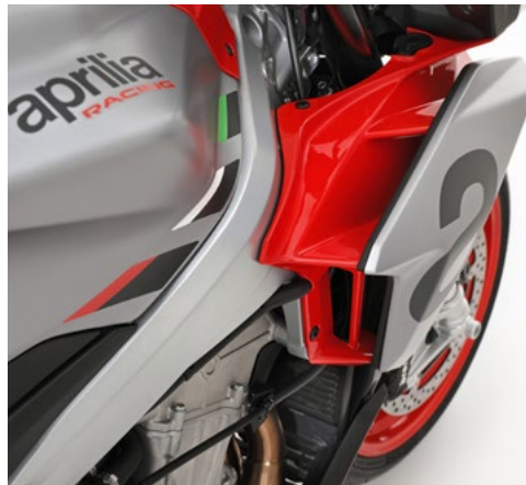
Ist das noch ein Naked Bike? Verkleidungshutzen leiten den Luftstrom an der Tuono
