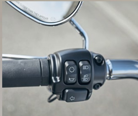
Bekannte Armaturen des Hauses. Der linke Schalter oben bedient das Cockpit
