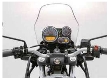
Retro-Cockpit: Drei analoge Runduhren und zwei Digital-Displays zeigen eine unerwartet üppige Informationsflut.
