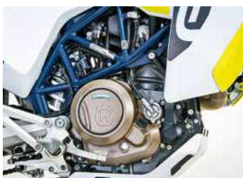
Gentransfer: Von KTM stammt das kurzhubige Einzylinder-Kraftpaket, das im Gitterrohrgeäst hängt.
