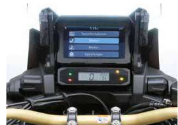
Alternative Anzeigen: Die wichtigen Informationen fürs Fahren stehen unten, der Rest im Farb-TFT darüber.
