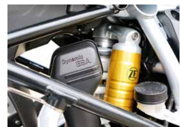
Elektronische Automatik: Beim Dynamic-ESA-Federbein von ZF stellt sich die Basis selbsttätig auf die Beladung ein.
