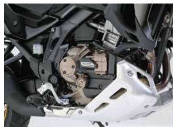
Ohne Abwürgen: Das DCT erübrigt sensiblen Umgang mit der Kupplung, eine Untersetzung macht Offroad-tauglich.
