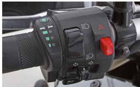
Grüne Ampel: Drei übereinander angeordnete LEDs zeigen die gewählte Heizstufe an.
