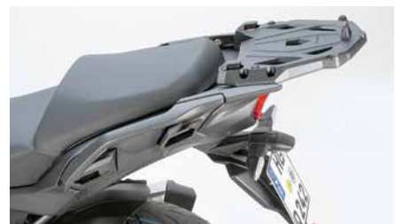
Hop on and off: Integrierte Aufnahmen machen die Montage und Demontage der Seitenkoffer zum Kinderspiel.
