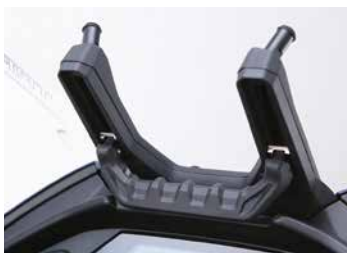
Mechanisch, praktisch, gut: praktikable Einhand-Verstellung der Scheibe für wunschgemäßen Wetterschutz.
