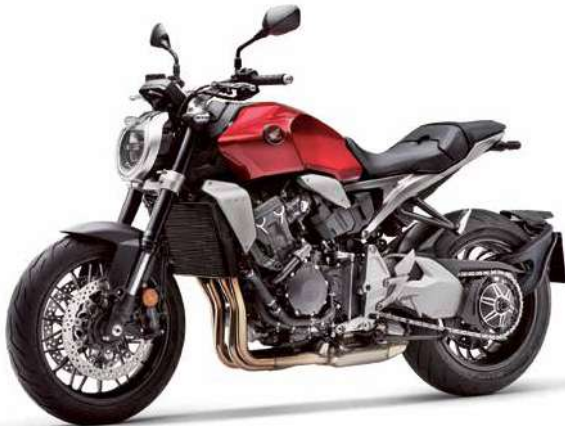
Reihen-Vierzylinder, Hubraum 998 cm 3 , Leistung 145,5 PS (107 kW) bei 10.500/min, max. Drehmoment 104 Nm bei 8250/min, Gewicht 212 kg
