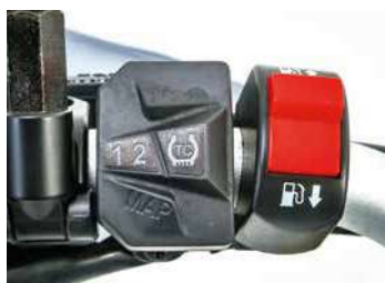
Mit links: Über die Schalter-Kombination werden Motor-Mapping, Traktionskontrolle und Tankauswahl bedient.
