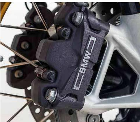
**Erdanker: Solide Festsattelbremsen von Hayes sind der neue Standard bei BMW**
