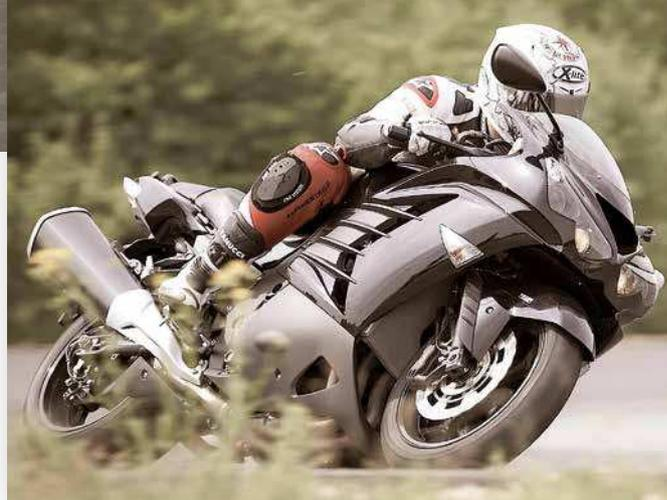
**Motor:** Vierzylinder-Viertakt-Reihe, **Hubraum:** 1441 cm<sup>3</sup> **Leistung:** 147 kW (200 PS) bei 10000 min<sup>-1</sup>, **Drehmoment:** 158 Nm bei 7500 min<sup>-1</sup>, **Tankinhalt:** 22 l, **Leergewicht:** 268 kg, **Preis:** 15982 Euro
