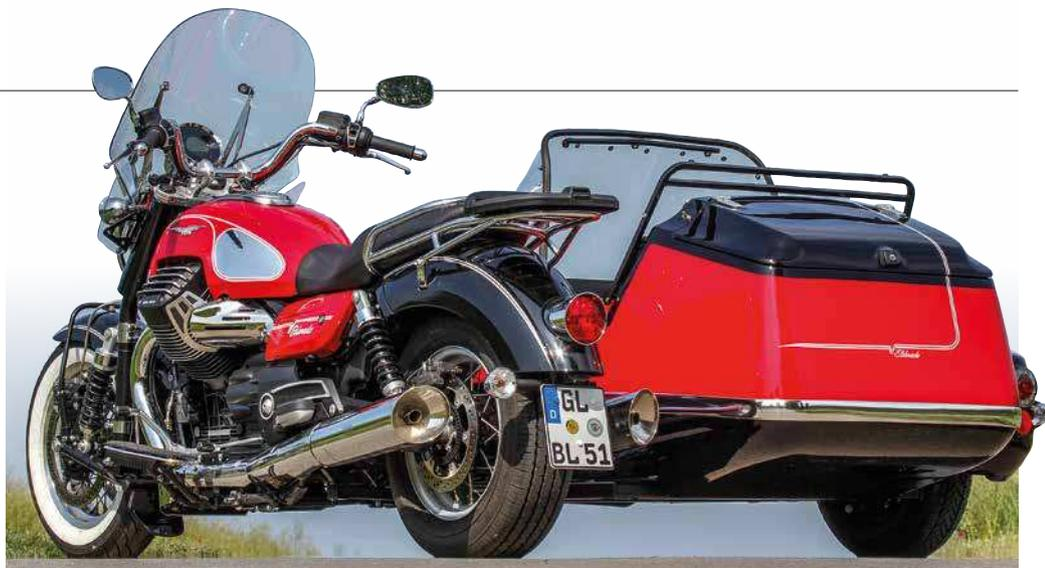
Dirigierbarkeit geboten scheint. Das Hinterrad ist für die Aufnahme eines langlebigen Pkw-Reifens auf 15 Zoll umgespeicht. Trotz kurzhubiger Auslegung produziert der Dampfhammer sein maximales Drehmoment bereits bei unter 3000 Touren, entsprechend schnell wäre der Originalreifen schon bei zurückhaltender Fahrweise am Ende. Bei artgerechter Nutzung als Tourer ist das ein teurer Spaß, weshalb sich die Umrüstung allemal rechnet. Vorne wie hinten kommen Dämpferelemente von Wilbers zum Einsatz.
