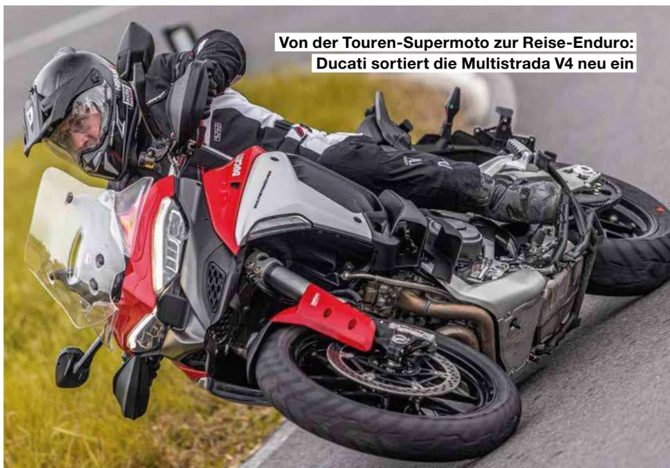
bei. Es liefert klares Feedback und hält die Multistrada V4 sauber in der Spur. Eine Niveauregulierung erkennt die Beladung und passt die Vorspannung selbstständig an. Zudem lässt sich das Fahrwerk übers Display elektronisch individuell einstellen.
