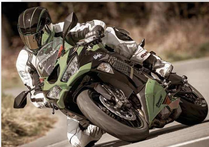
**Motor:** Vierzylinder-Viertakt-Reihe **Hubraum:** 636 cm<sup>3</sup>, **Leistung:** 95 kW (130 PS) bei 13500 min<sup>-1</sup>, **Drehmoment:** 71 Nm bei 11000 min<sup>-1</sup>, **Tankinhalt:** 17 l, **Leergewicht:** 196 kg, **Preis:** 11400 Euro
