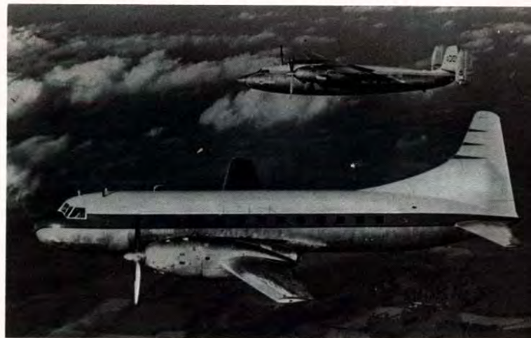
CONVAIR CV-340 für Mittelstrecken. Zwei Motoren mit je 2400 PS, 44 Passagiere, Höchstgeschwindigkeit 504 km/st in 7000 m Höhe, Reichweite 1670 km.
