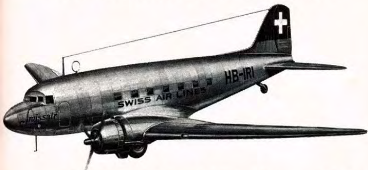
DOUGLAS DC-3, auch DAKOTA genannt. 2 Doppelsternmotoren mit je 1200 PS, bis 32 Passagiere, Fluggeschwindigkeit 300 km/st. Etwa 13 000 Stück wurden gebaut. Während des Krieges diente sie als Truppentransporter.
