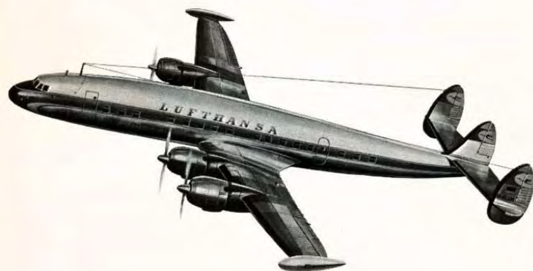
LOCKHEED L-1049 G SUPER CONSTELLATION, Baujahr 1951. 4 Doppelsternmotoren mit je 3250 PS, bis 94 Passagiere, Höchstgeschwindigkeit 530 km/st in 6000 m Höhe, Reichweite 7400 km.
