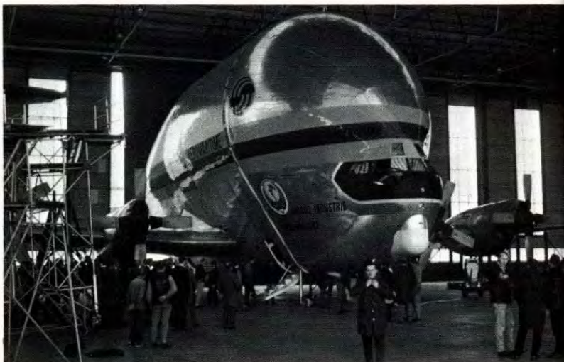
SUPER GUPPY, ein Lastenflugzeug, das fast 23 Tonnen Fracht mit 483 km/st Geschwindigkeit befördern kann.
