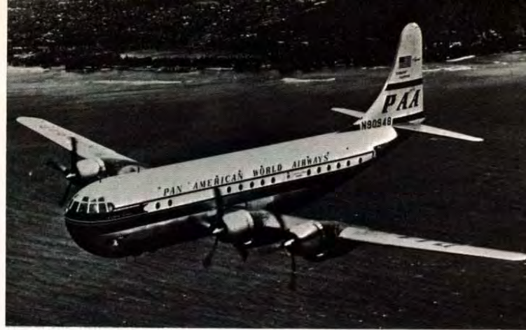
BOEING B 377 „STRATOCRUISER“, Erstflug 1944. 4 Sternmotoren mit je 3500 PS, 75 Passagiere, Geschwindigkeit 545 km/st, Reichweite 7400 km. Bis Ende der 50er Jahre im Linienverkehr.
