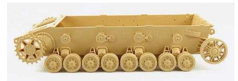
**6** Verlängerte Seitenwände, vier Stützrollen, Abweiser für die Kettenbolzen, gegossene Leiträder, fehlende Schrauben am Rollenwagen
