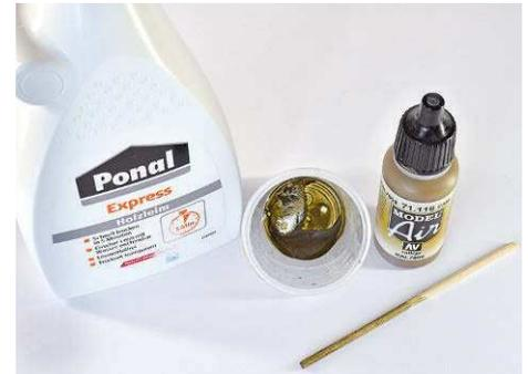
In den Holzleim rührt man die gewünschte wasserlösliche Farbe ein. Ist die Mischung noch zu flüssig, mit mehr Holzleim eindicken
