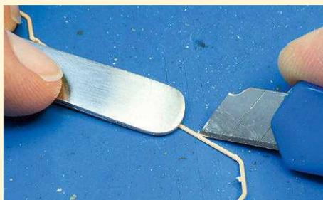
**5** Dünne Teile bedürfen beim Entgraten Stabilität. Mit dem Pinzettenschaft auf der Unterlage fixieren, mittels Cutter versäubern
