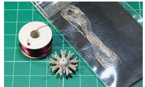
**21** Um einen Bohrschaft verdrillt, kommt Draht als „Zündverteiler“ an seine Position; Bohrungen für die Zündkabel
