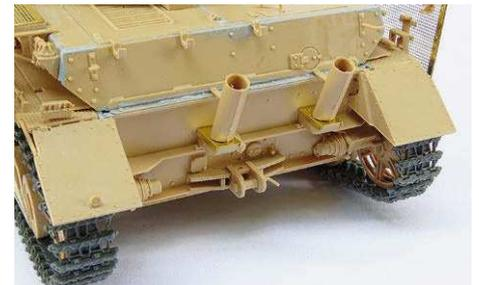
**4** Späte Produktionsänderungen: Am Heck zu beachten sind die Flammvernichter und die späte geänderte Schleppkupplung
