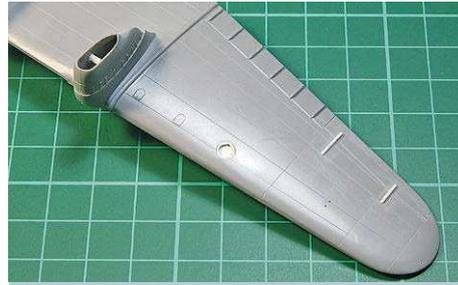
**15** Die Delta 1C hatte auf der Unterseite nur zwei Stelltriebe für die Querruder, heißt: drei alte runter und zwei neue drauf
