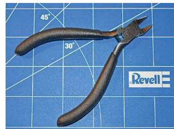
Sauber gearbeitetes Werkzeug zum optimalen Heraustrennen filigraner Teile mit lediglich zehn Millimeter langen, spitz zulaufenden Schneiden und rutschfesten, umschäumten Griffen für ausschließliches Arbeiten mit Kunststoff! HSD ★★
