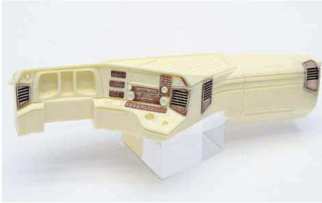
**3** Aus zehn Bauteilen besteht das Armaturenbrett, Ätzteile detaillieren ergänzend zum Resin. Für die Instrumente liegen Decals bei
