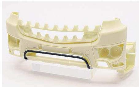
**6** Lediglich der Stoßbügel vorne ist neu aufgebaut. Dafür passt Blumendraht in einer Stärke von 1,5 Millimeter sehr gut
