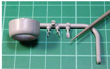
**20** Die Aussparung oben auf der Motorverkleidung ist zu schließen und der markante, umlaufende Spannring nachzugravieren
