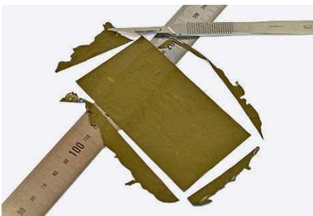
Mit einer frischen Skalpellklinge und einem (Stahl)Lineal lässt sich die gewünschte Kontur der Plane leicht zuschneiden
