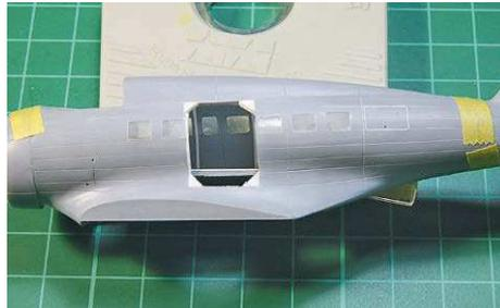
**7** Der Kabinenboden lag unterhalb der Einstiegskante und sollte gute zwei Millimeter tiefer liegen. Da hilft nur eine Neuanfertigung
