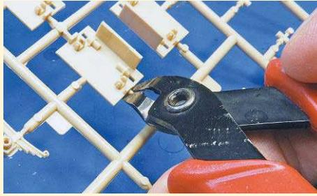
**2** Die einzelnen Teile sind schön stabil ausgeführt. So kann man beim Abtrennen auch einen Seitenschneider verwenden
