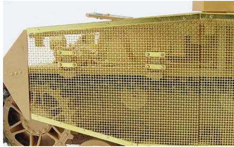
**14** Die Schürzen bestehen fast komplett aus Ätzteilen, lediglich die Halterungen sind aus Plastik. Nicht die Struktur verkleben!
