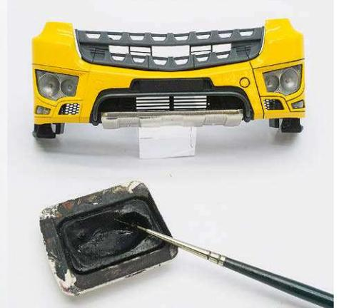
**19** Farbe auf Wasserbasis löst den Kabinenlack nicht an – ideal also, um Fugen und Gravuren gefahrlos auslaufen zu lassen (rechts)
