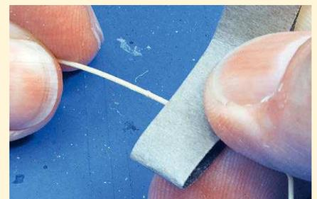
**6** Die Rahmenantenne weist aus Formbaugründen eine Mittelnaht auf; mit feinkörnigem Schleifpapier abschleifen
