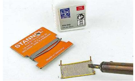
**15** Zur stabileren Verbindung die Zusatzpanzerung verlöten! Weiches Lötzinn und Flussmittel erleichtern die Arbeit
