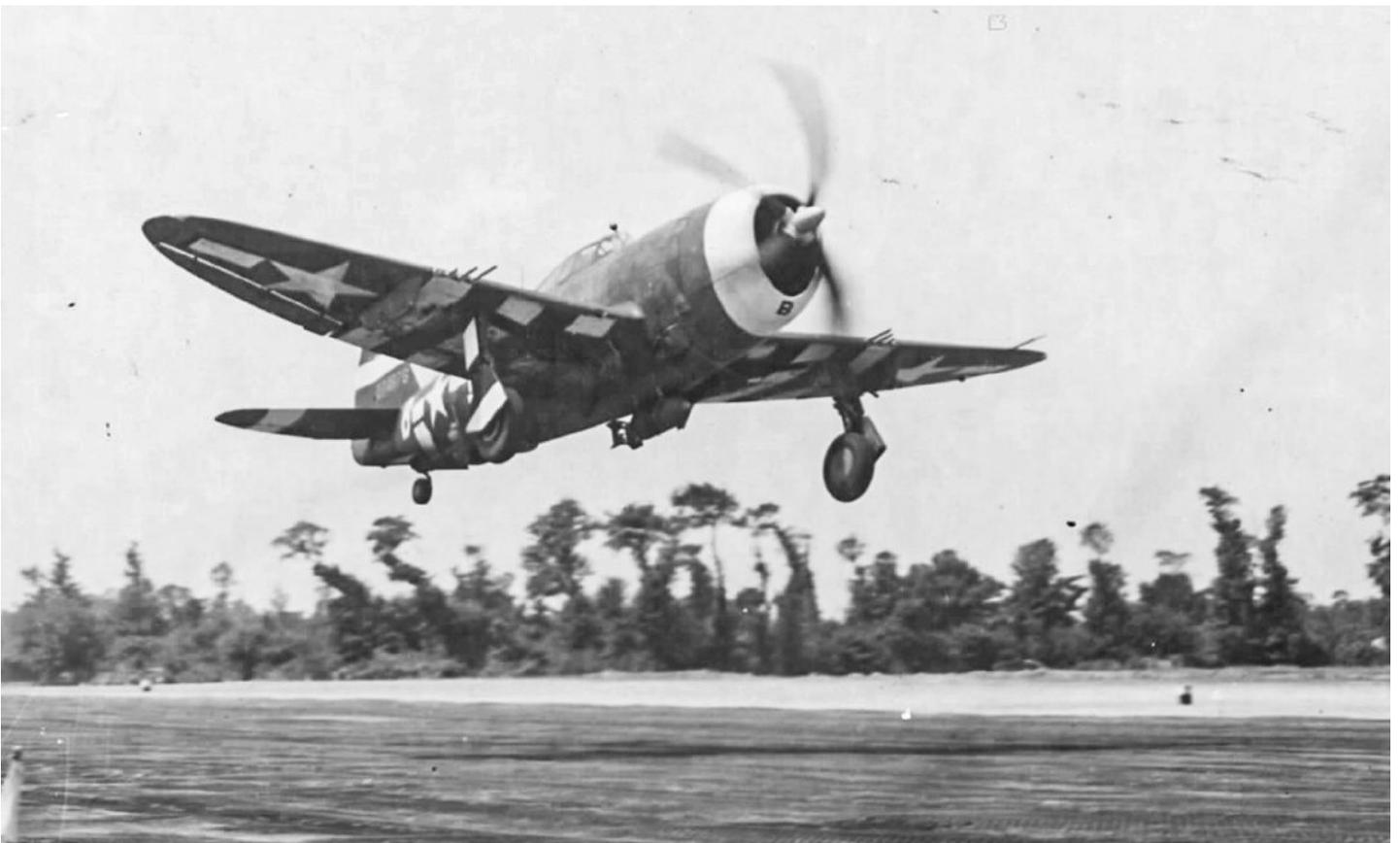
Mit einer Bombe unter dem Rumpf startet diese P-47 am 6. Juni 1944. Die aufgebrachten Steifen an Flächen und Rumpf dienten der Identifizierung.
