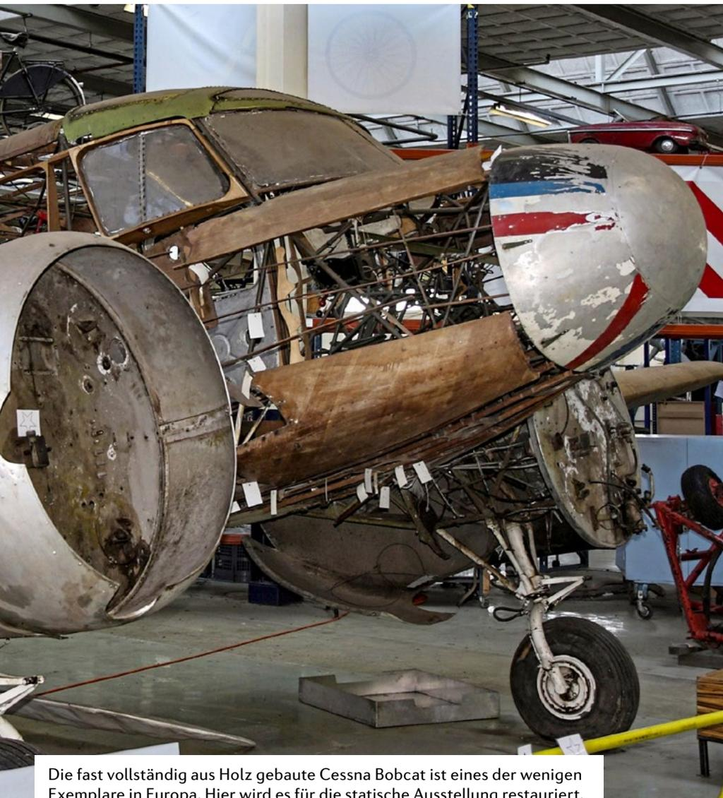
Die fast vollständig aus Holz gebaute Cessna Bobcat ist eines der wenigen Exemplare in Europa. Hier wird es für die statische Ausstellung restauriert.
