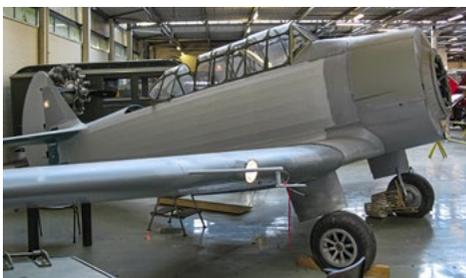
Aus einer Harvard wird öffentlich einsehbar eine NA-16 entstehen.
