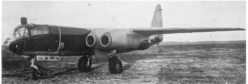
Die erbeutete Ar 234 C mit originalen deutschen Rumpfmarkierungen verfügte über jeweils zwei unter den Flächen montierte Triebwerke.
