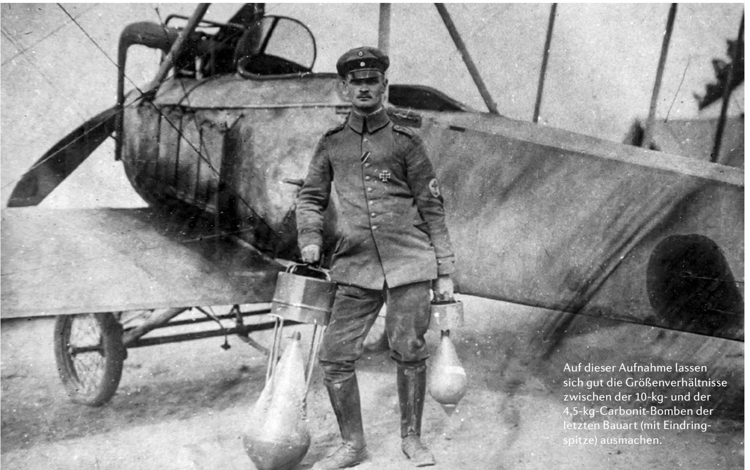
Auf dieser Aufnahme lassen sich gut die Größenverhältnisse zwischen der 10-kg- und der 4,5-kg-Carbonit-Bomben der letzten Bauart (mit Eindringspitze) ausmachen.
