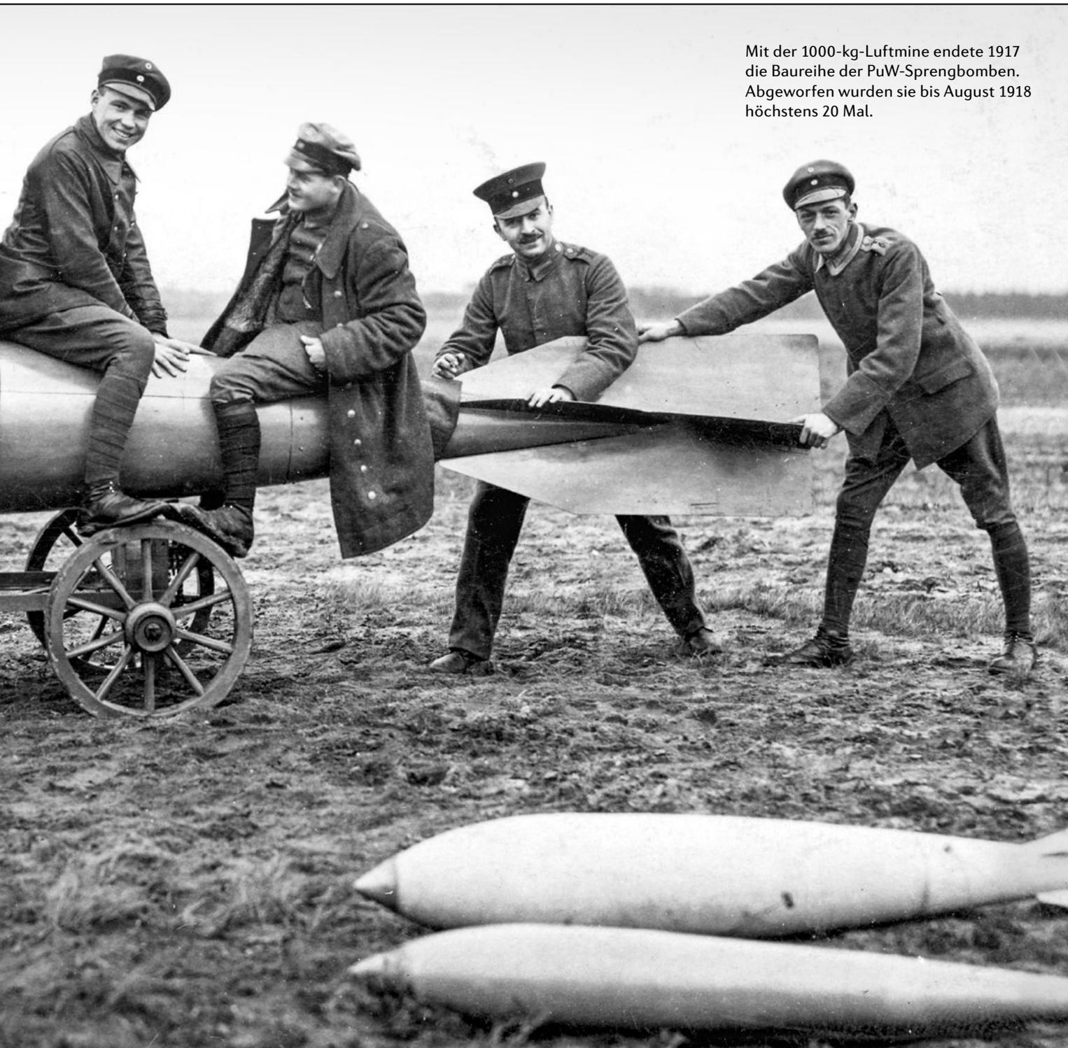
Mit der 1000-kg-Luftmine endete 1917 die Baureihe der PuW-Sprengbomben. Abgeworfen wurden sie bis August 1918 höchstens 20 Mal.
