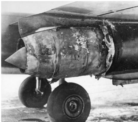
Die Folgen eines Brandes am rechten Triebwerk der Ar 234 B-2 im Jahr 1946.
