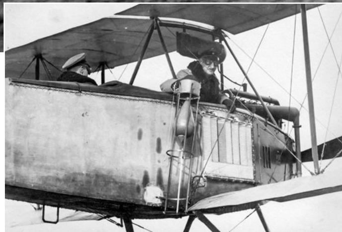
Aviatik P 14, Januar 1915. Die 4,5-kg-Carbonit-Sprengbomben wurden beim Abwurf mittels eines Stahlrohrkorbs stabilisiert.
