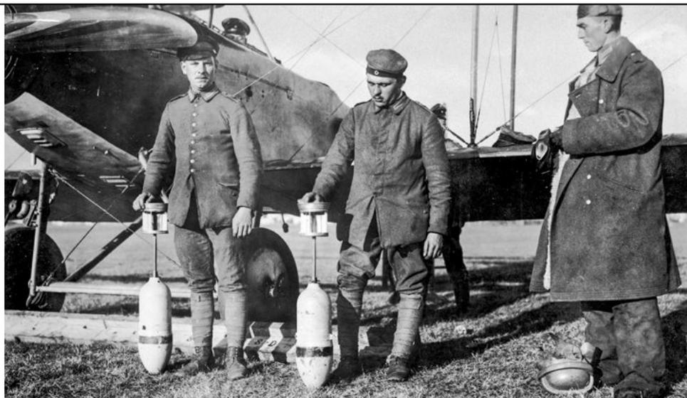
Zu den bis ins Jahr 1916 reichenden Behelfslösungen gehören sogenannte Nacheilbomben. Die Bauchbinde lässt ein umgebautes Artilleriegeschoss vermuten. Das an langen Stangen angebrachte Leitwerk dürfte wenig zur Ballistik beigetragen haben.
