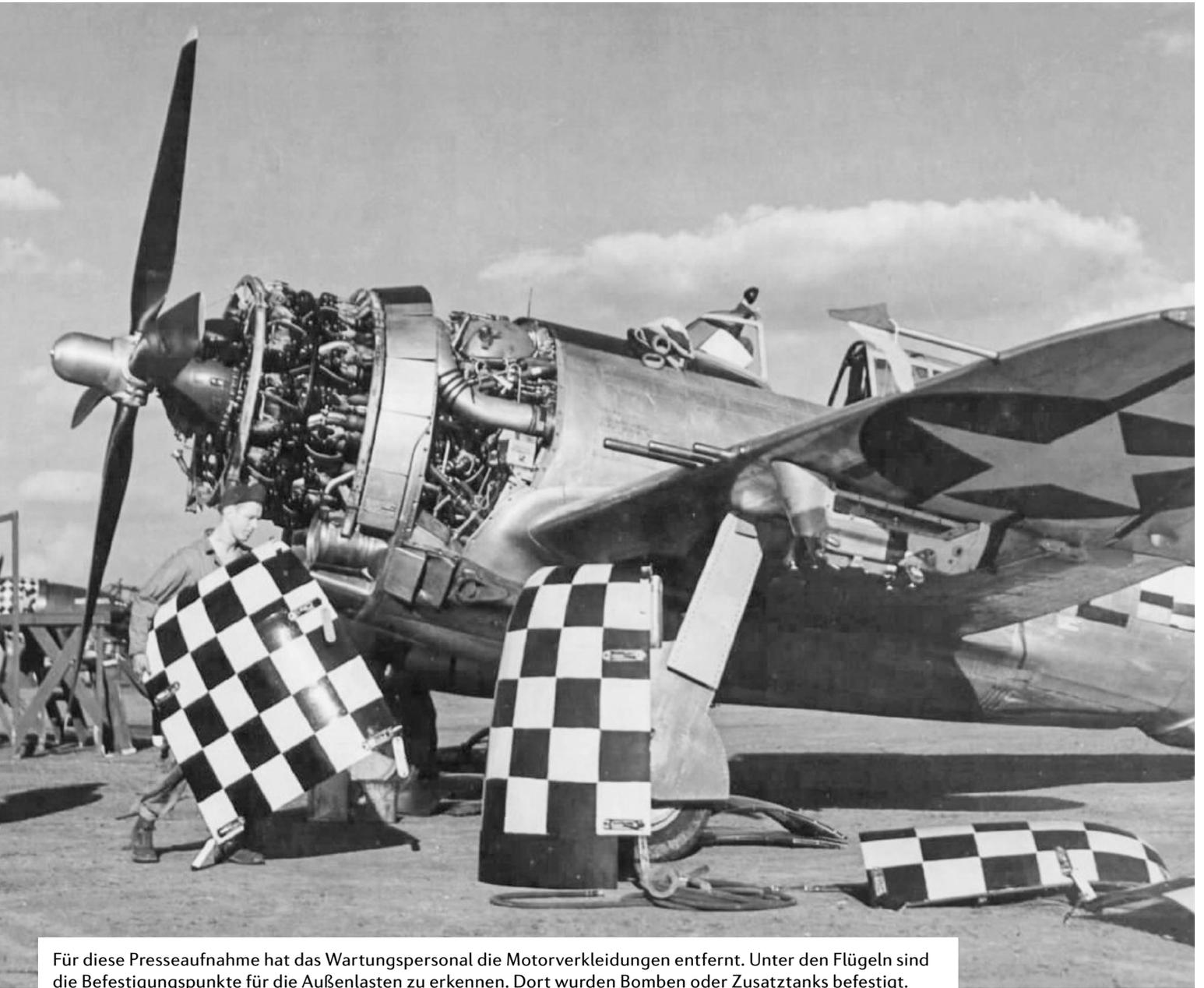
Für diese Presseaufnahme hat das Wartungspersonal die Motorverkleidungen entfernt. Unter den Flügeln sind die Befestigungspunkte für die Außenlasten zu erkennen. Dort wurden Bomben oder Zusatztanks befestigt.
