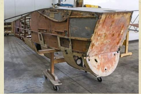
bespannt werden. Über den Winter arbeiten unsere Techniker an der **Überholung des Rumpfes**, wobei alle Metallbeschläge bereits überholt worden sind. Auch wurde die hölzerne Struktur entölt und entlackt und ist somit fertig zur weiteren Bearbeitung.
