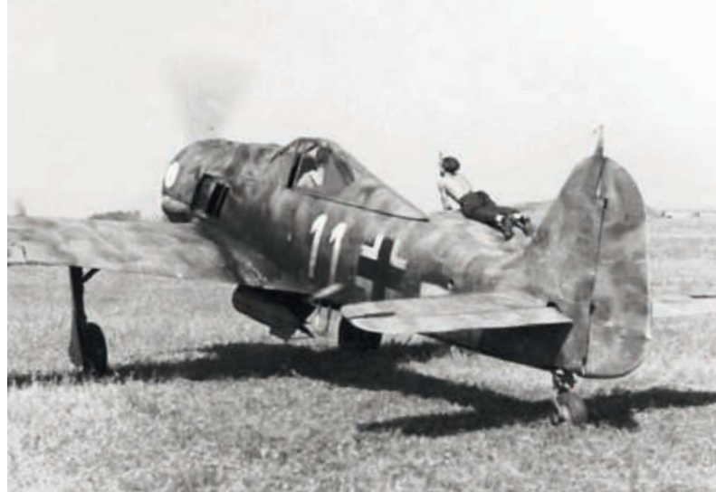
Ein Mitglied der Bodenmannschaft weist die Fw 190 F-8 »Weiße 11« der I./SG 4 beim Rollen zum Start ein. Die F-8 ist mit einem Abwurfbehälter ausgerüstet
