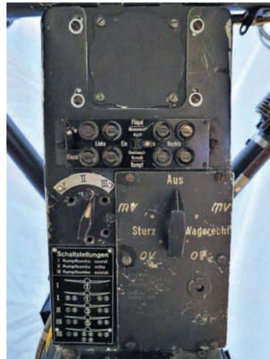
Restaurierte Mittelkonsole der Fw 190 F-8/R1 mit der Übersichtstabelle Foto Privatsammlung
