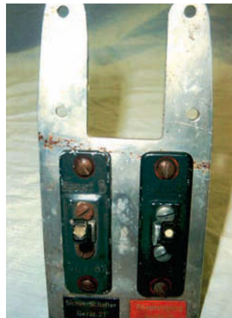
RECHTS Die Schalter für die 21-cm-Raketen waren oben in der Mittelkonsole integriert
