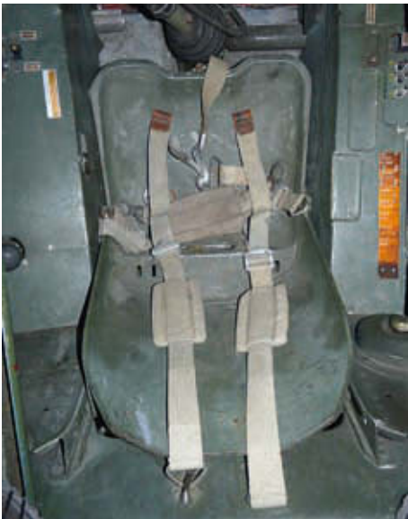
Der Pilotensitz der Fw 190 A-8. Er war für einen Rückenfallschirm ausgelegt
