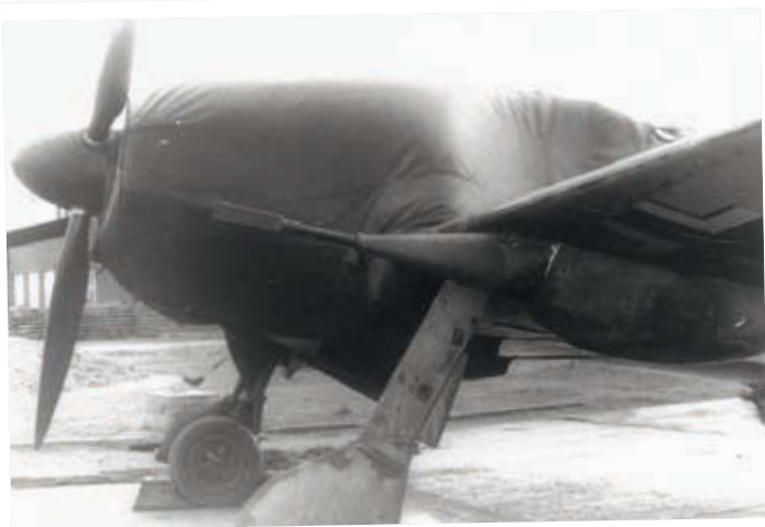
LINKS Die MK 103 mit Mündungsbremse und Laufabstützung
