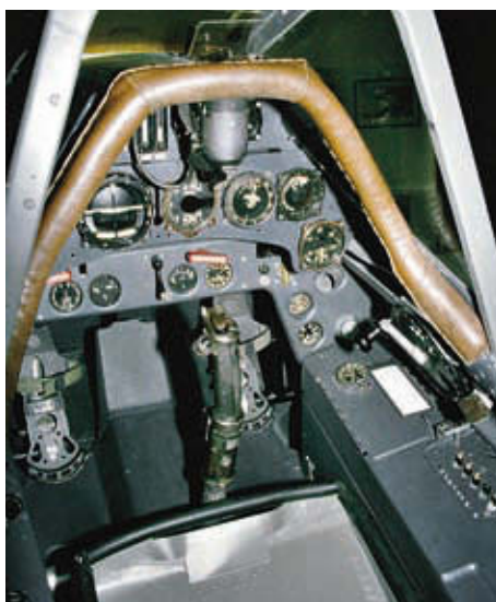
Cockpit der Fw 190 A-8 im Luftfahrtmuseum Laatzten. Eingebaut ist hier jedoch ein Revi C/12D anstatt des Revi 16. Die Mittelkonsole fehlt
