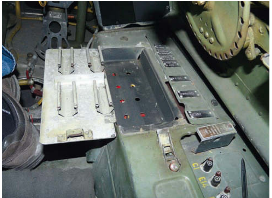
Ein selten gesehenes Detail: Der geöffnete Kasten für die Leuchtpatronen auf der rechten Gerätebank
