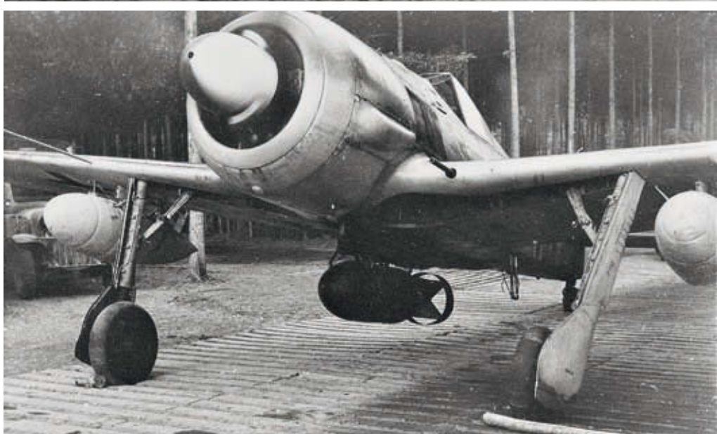
Dieser einsatzbereite Fw-190-Jagdbomber vom Schnellkampfgeschwader 10 trägt zwei Zusatz-tanks unter den Flügeln. Fw 190 vom SKG 10 schossen in der Nacht mehrere RAF-Bomber ab
