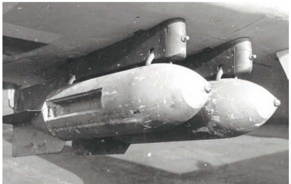
Der neue ETC 71 mit eingehängener Bombenlast (Übungsbomben aus Beton)
