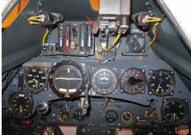
Sorgfältig restaurierte Instrumentierung einer F-8/R1. Das Revi 16 B hat links den nachträglich montierten Hebel »Stiefelchen« fürs Farbglas Foto Privatsammlung
