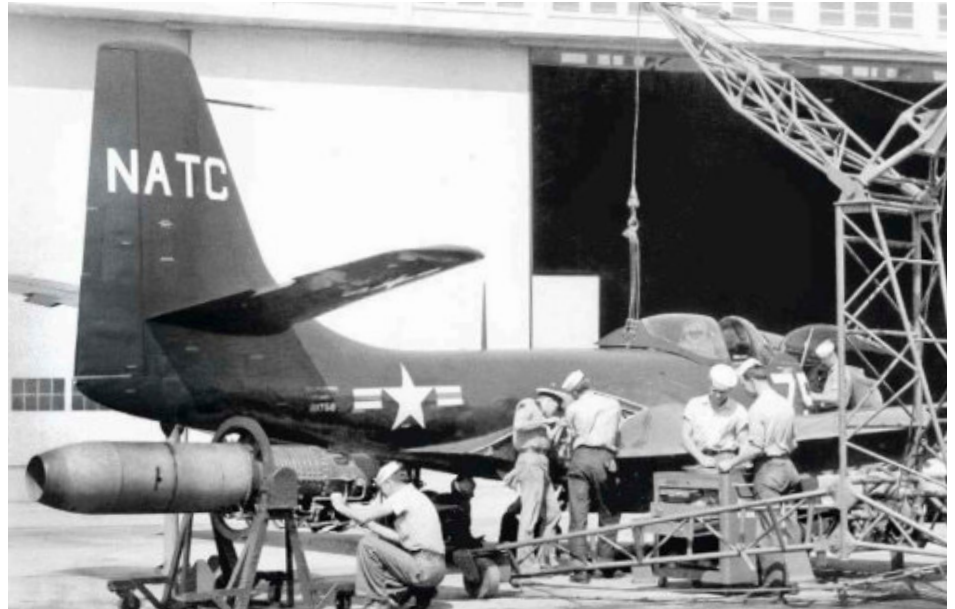
Die Westinghouse J-30-WE-Triebwerke der Phantom muss man in außerordentlich kurzen Intervallen überholen beziehungsweise wechseln Foto USN/Sammlung Wolfgang Mühlbauer
