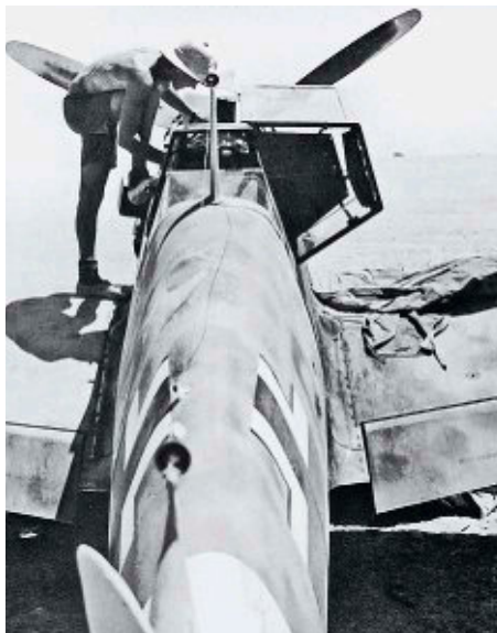
Bf 109 E/Trop der I./J.G. 27 während der Wartung, die im Wüsteneinsatz deutlich aufwendiger war. In der Kabinenhaube ist die Rücken- und Kopfpanzerplatte zu sehen
