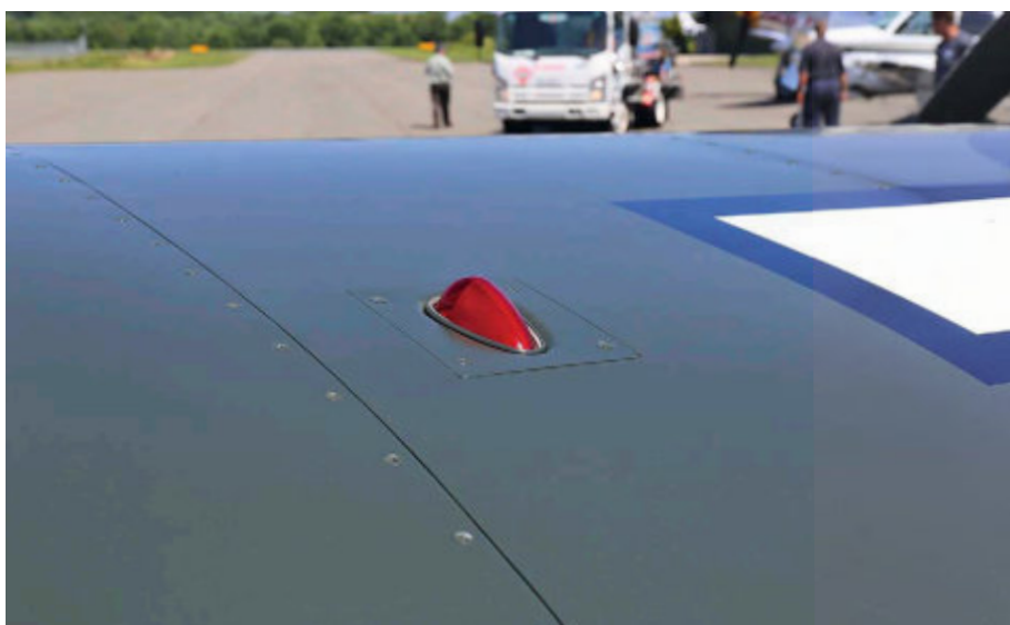
Die Positionslichter der B-Mustang sind auf dem Flügel angebracht
