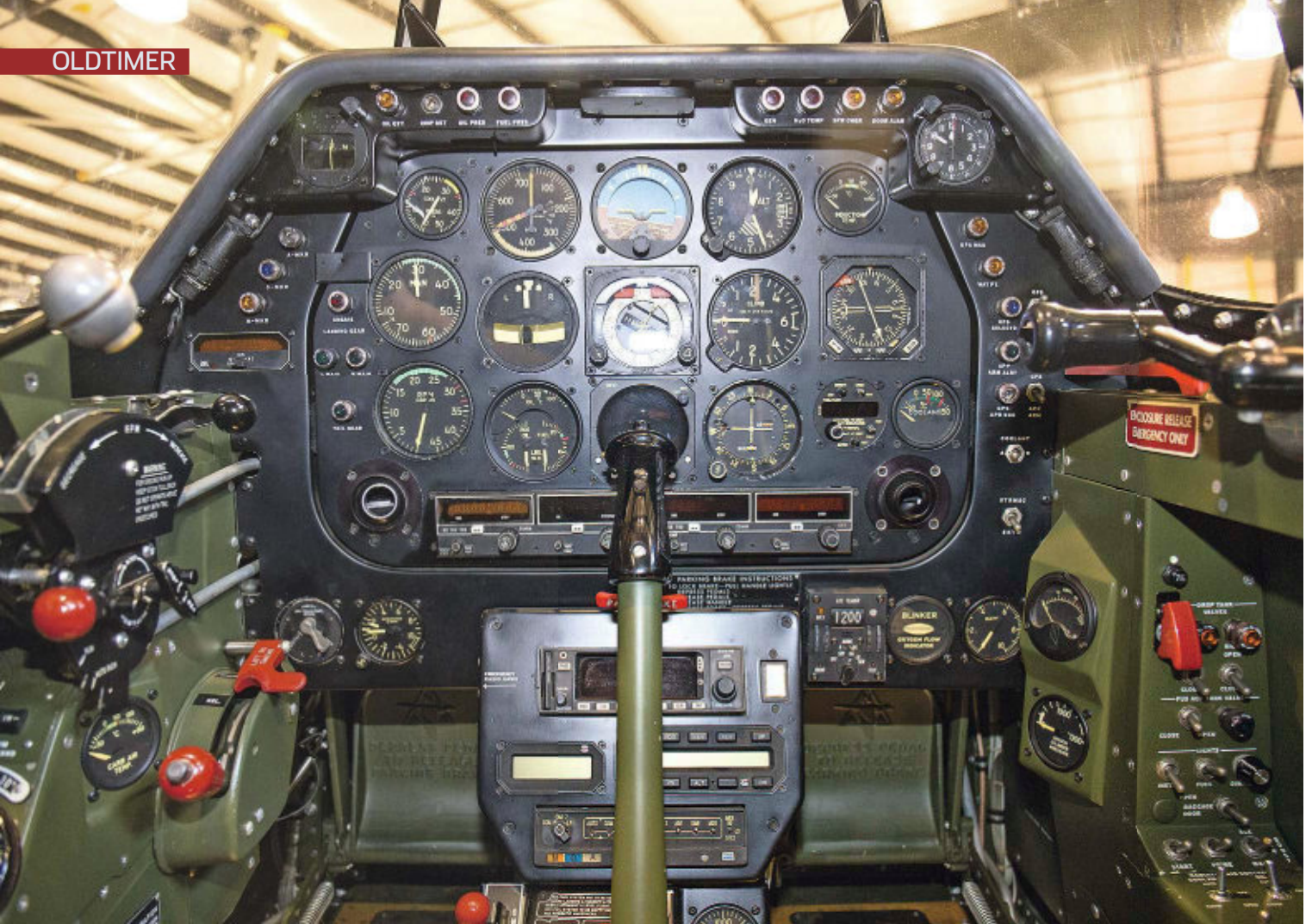
Armaturenbrett: Bis auf zwei moderne Navigationsinstrumente und einem künstlichen Horizont sowie der Funkanlage befindet sich die Mustang im Originalzustand
