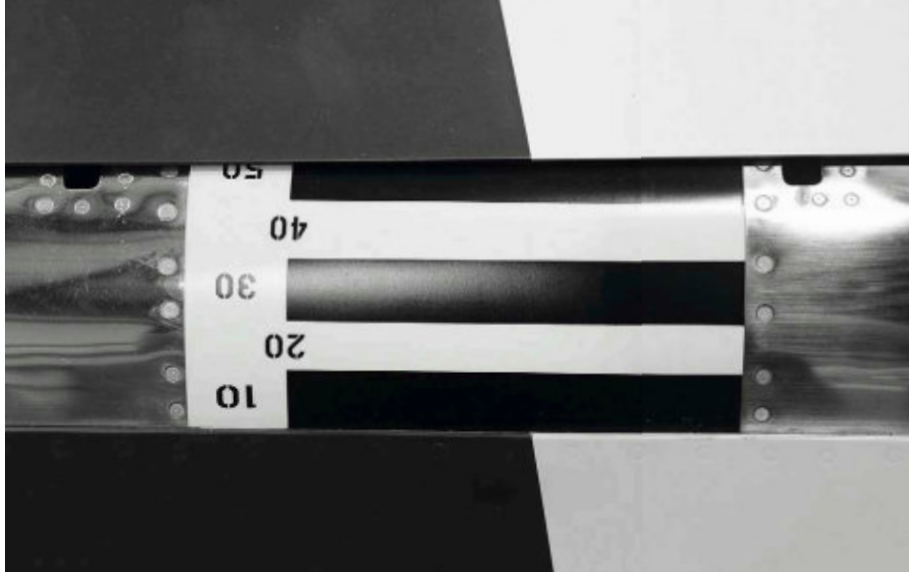
Maximal um 50 Grad lassen sich die Landeklappen ausfahren, wie die Anzeige verrät
