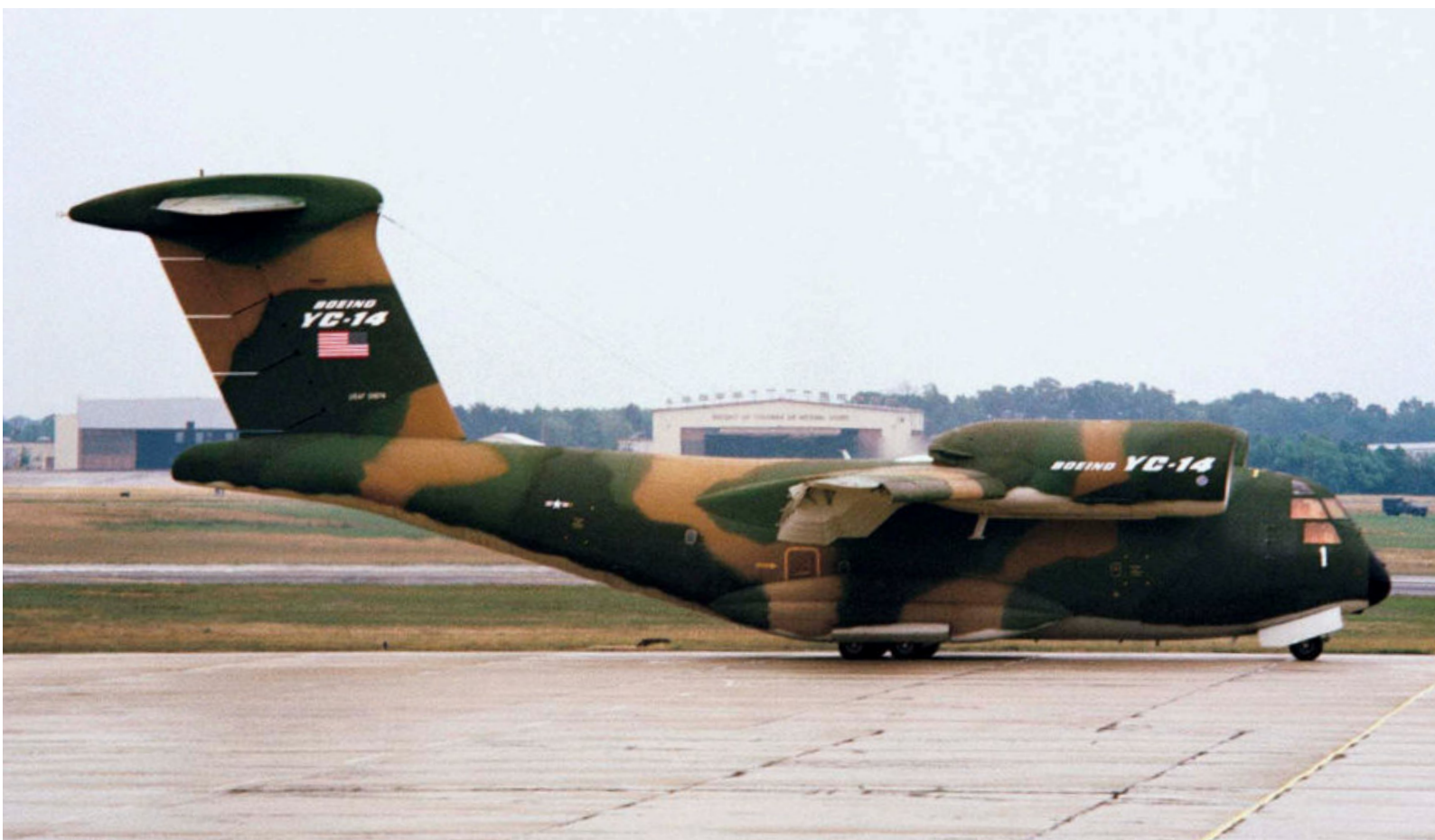
Vorflügel ganz ausgefahren, Schubumkehr aktiv: Boeing YC-14 A, s/n 72-1874, im statischen Erprobungsbetrieb
