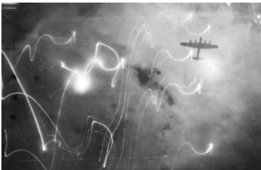
Einfaches, funkttechnisches Störmittel: Aluminiumstreifen (siehe helle »Wolke« links), wie hier abgeworfen von einem Lancaster-Bomber
