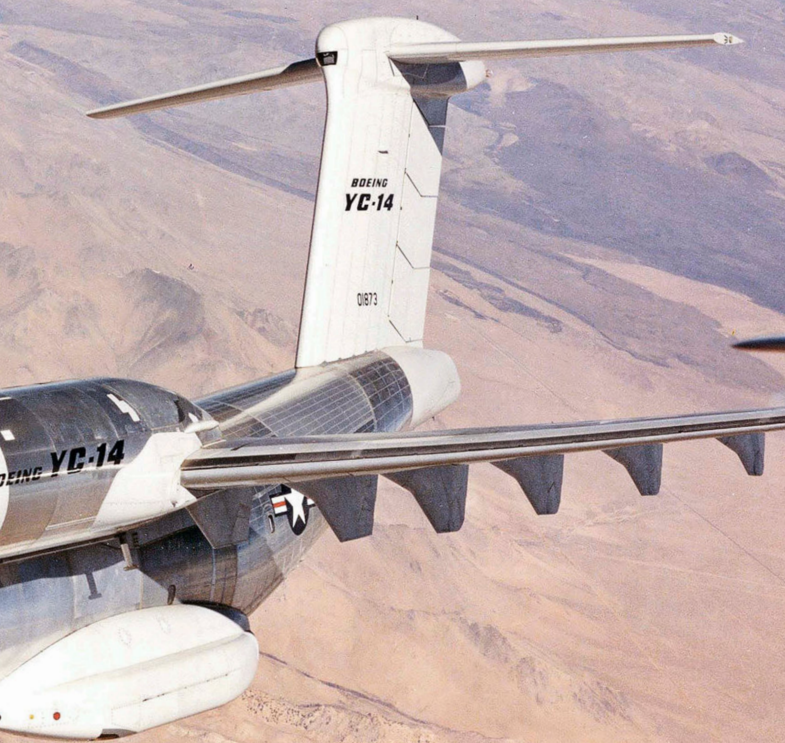
In dieser Flugaufnahme der Boeing YC-14 A, s/n 72-1873, wird die unkonventionelle Anordnung der beiden Turbofan-Triebwerke General Electric CF6 50D besonders gut deutlich
