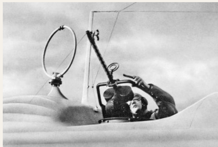
Bordschützenschulung auf dem Rumpfrücken einer Fw 58 B im B-Stand mit 7,92-mm-MG-15 auf Drehkranz 30
