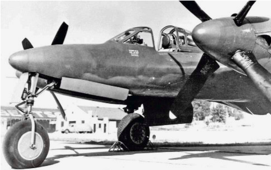
Ein innovatives Merkmal der XP-67 ist das Bugfahrwerk, das sich in der Folge ebenso bei der XFD-1 findet
