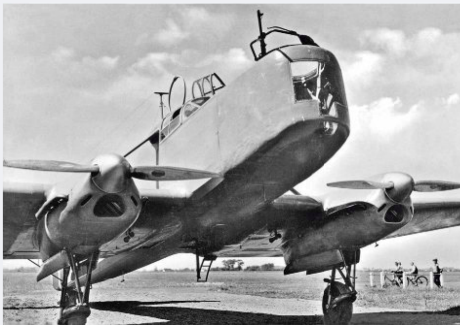
Die Version Fw 58 A-1 mit dem frühen A-Stand, der sich noch an dem völlig veralteten Kampfflugzeug Dornier Do 23 (Do 11/13) ausrichtete
