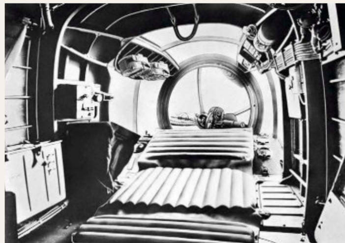
Der vordere Abwehrstand einer Fw 58 B-2 mit MG 15. Dem liegenden Schützen standen drei Doppeltrommeln mit je 75 Schuss zur Verfügung, von denen zwei im Trommelträger 33 hängen
