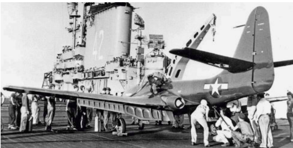
Die gesamte Leitwerkspartie der XFD-1 zeigt unverkennbare Anleihen bei der XP-67
