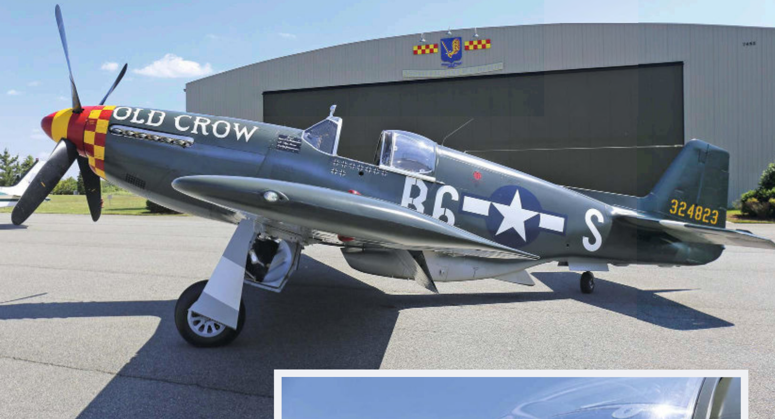
»Old Crow« vor passend gebautem und klimatisiertem Hangar. Gut zu erkennen ist das Laminarprofil des Mustangflügel
