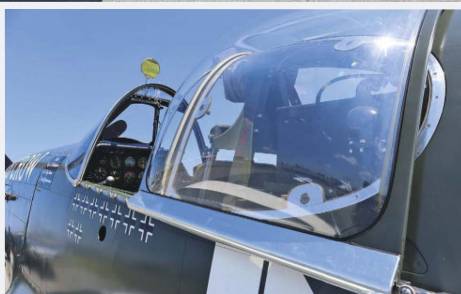
Die Malcom-Haube der Spitfire MK V. Ebenfalls von der Spitfire übernommen: der Rückspiegel
