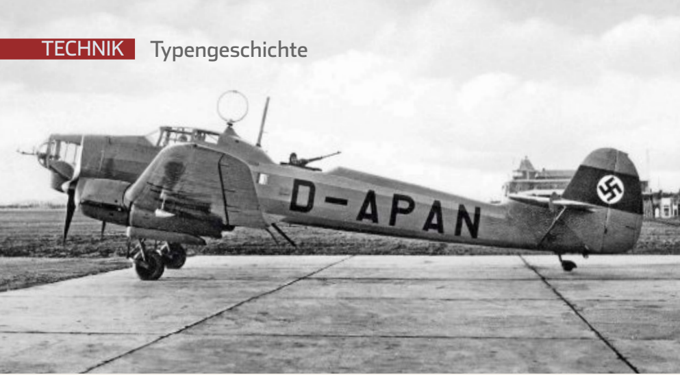
Fw 58 B-2 mit A- und B-Stand, wie sie zur Schulung von Beobachtern und Bombenschützen sowie MG-Schützen und Funkern zum Einsatz kam. Hinter der Kabine ragt der Peilrahmen des Peil-Empfängers auf, der Teil der funktechnischen Ausrüstung war
