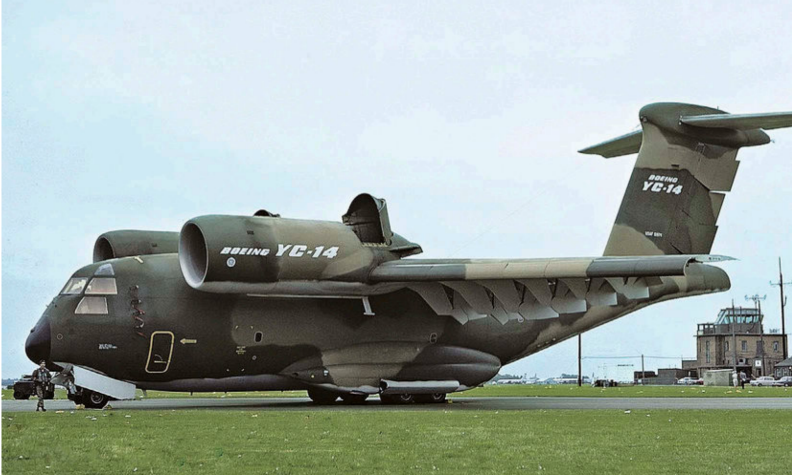
Vorflügel ganz ausgefahren, Schubumkehr aktiv: Boeing YC-14 A, s/n 72-1874, im statischen Erprobungsbetrieb
