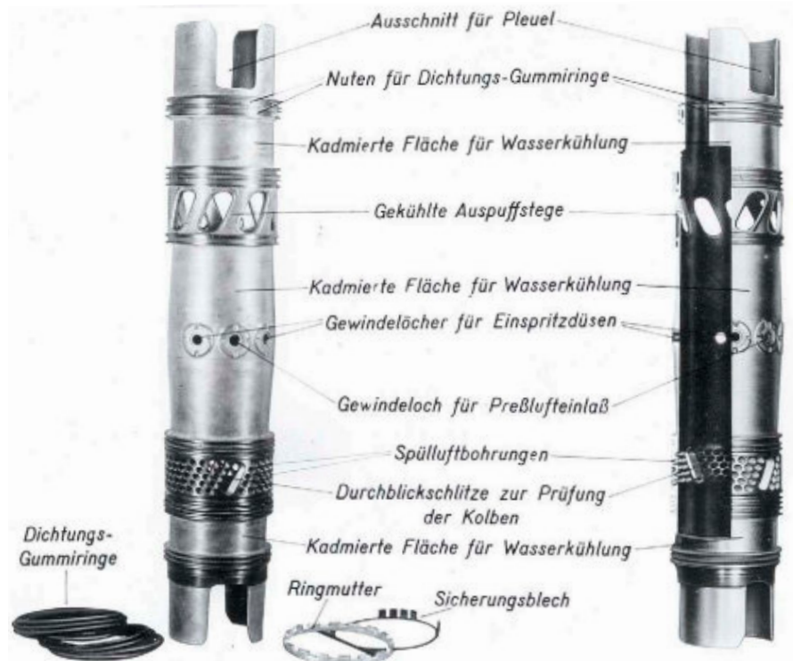
Die Zylinder-Laufbuchsen des Jumo 205 waren mit ihren radialen Schlitzen und Bohrungen das Produkt einer jahrzehntelangen hochkomplizierten Forschung und praktischer Erprobungen
