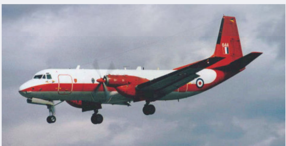
Spotter-Schreck: Wenn sie kam, war oft lange nichts mehr zu sehen. Denn die Andover E.3 war auf die Kalibrierung der elektronischen Navigationshilfen von Flugplätzen spezialisiert und benötigte für diese Rolle einen möglichst ungestörten Luftraum
