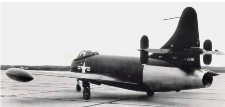
Die serienmäßige F6U-1 trägt vertikale Stabilisierungsflächen an den Höhenflossen; das Seitenleitwerk ist nochmals vergrößert
