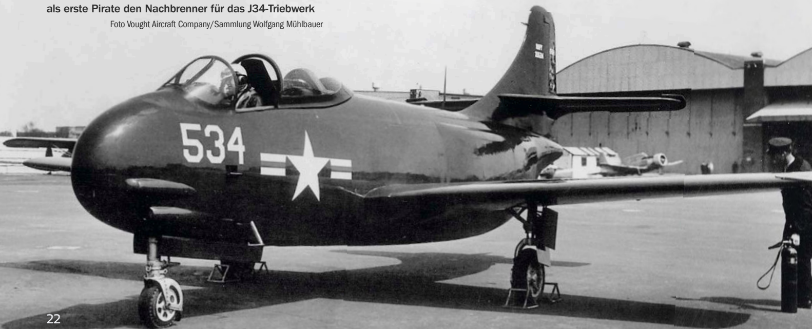
Der dritte Prototyp in seiner alten Form. Er erhält später als erste Pirate den Nachbrenner für das J34-Triebwerk
