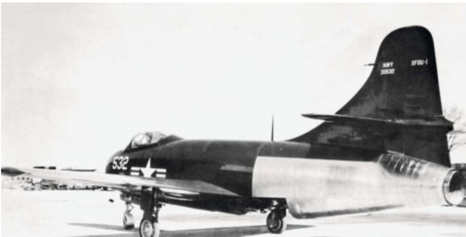
Dasselbe Flugzeug nach der Umrüstung auf den Nachbrenner – mit verlängertem Heck sowie nach vorne erweiterter Seitenflosse
