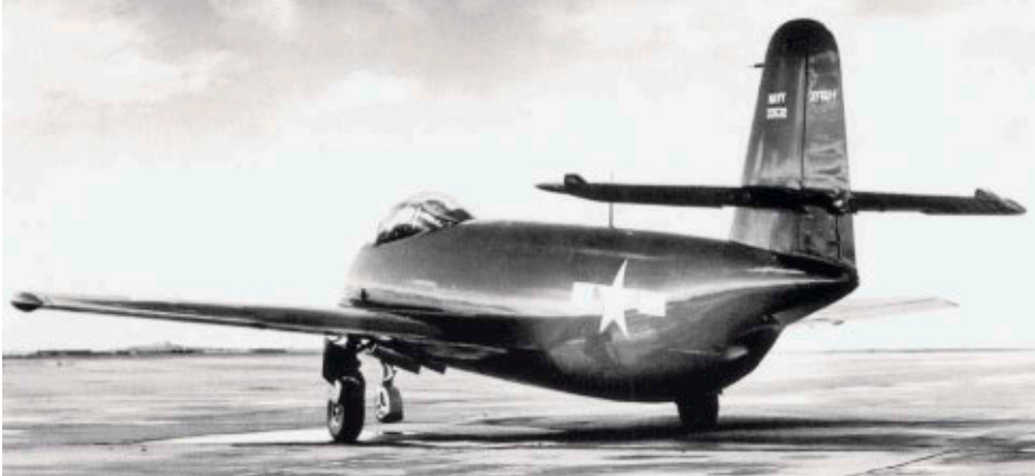
Rumpfheck sowie Höhen- und Seitenleitwerke der ersten XF6U-1 in ihrer anfänglichen Form und Gestalt
