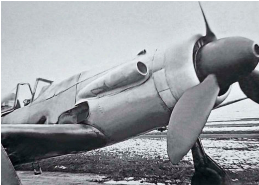
Die Fw 190 V20 mit Jumo-213-Einheitstriebwerk und eingebauter Flammenvernichter-Anlage. Das Triebwerk war serienmäßig vorgesehen für die neue Focke-Wulf Ta 152 A
