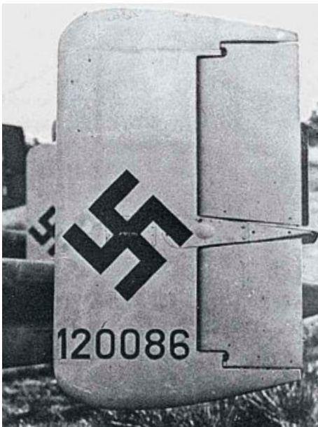
Der Triebwerksstrahl saugte das Seitenruder an, was den Piloten Probleme bereitete
