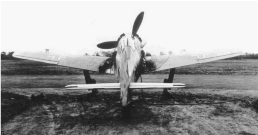
Rückansicht der V21. Die Flammenvernichter-Anlage hat deutlich sichtbare Abgaspuren auf der Tragflächen-Oberseite hinterlassen
