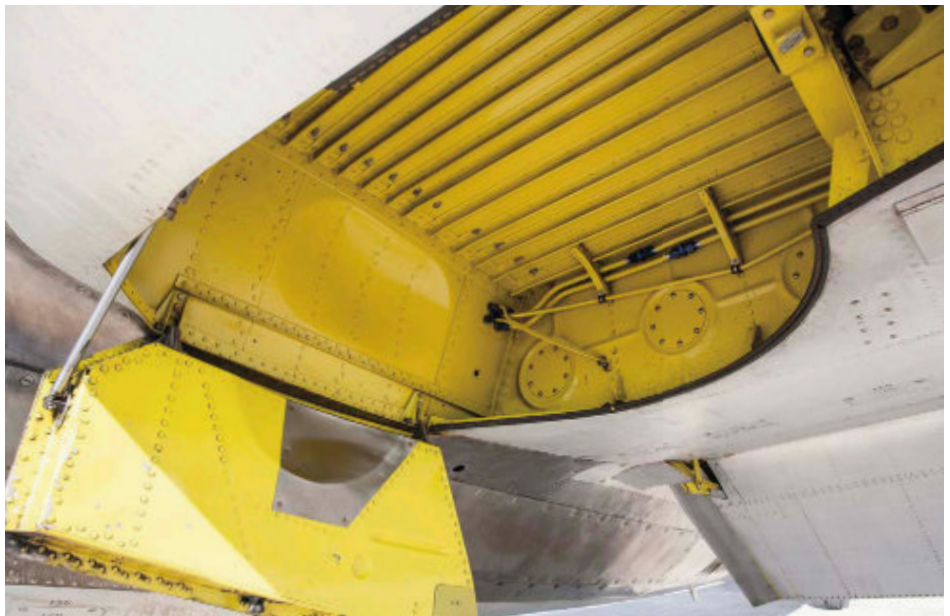
»Wheel well«: Hier ist das Fahrwerk im Flug untergebracht
