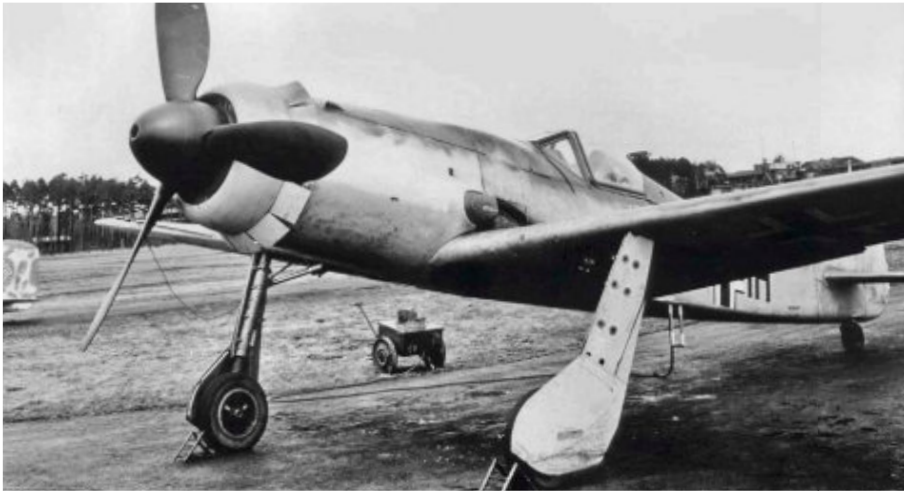
Sie war erst im Frühjahr 1944 fertig, die Fw 190 V21. Man sieht deutlich den geänderten Abgasaustritt beim Flammenvernichter gegenüber der V20
