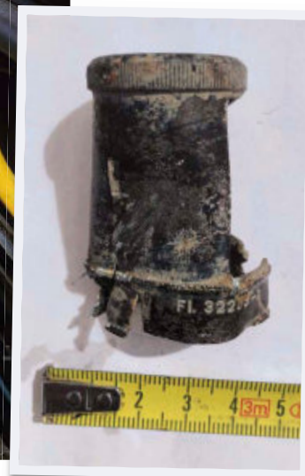
Auch Überreste aus dem Cockpit konnte das Team bergen: Zum einen der Drehzahnmesser des Motors und ...
