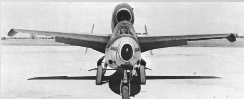
Im Gegensatz zur M1 hatten die Einsatzmaschinen keine geraden Flügelspitzen mehr
