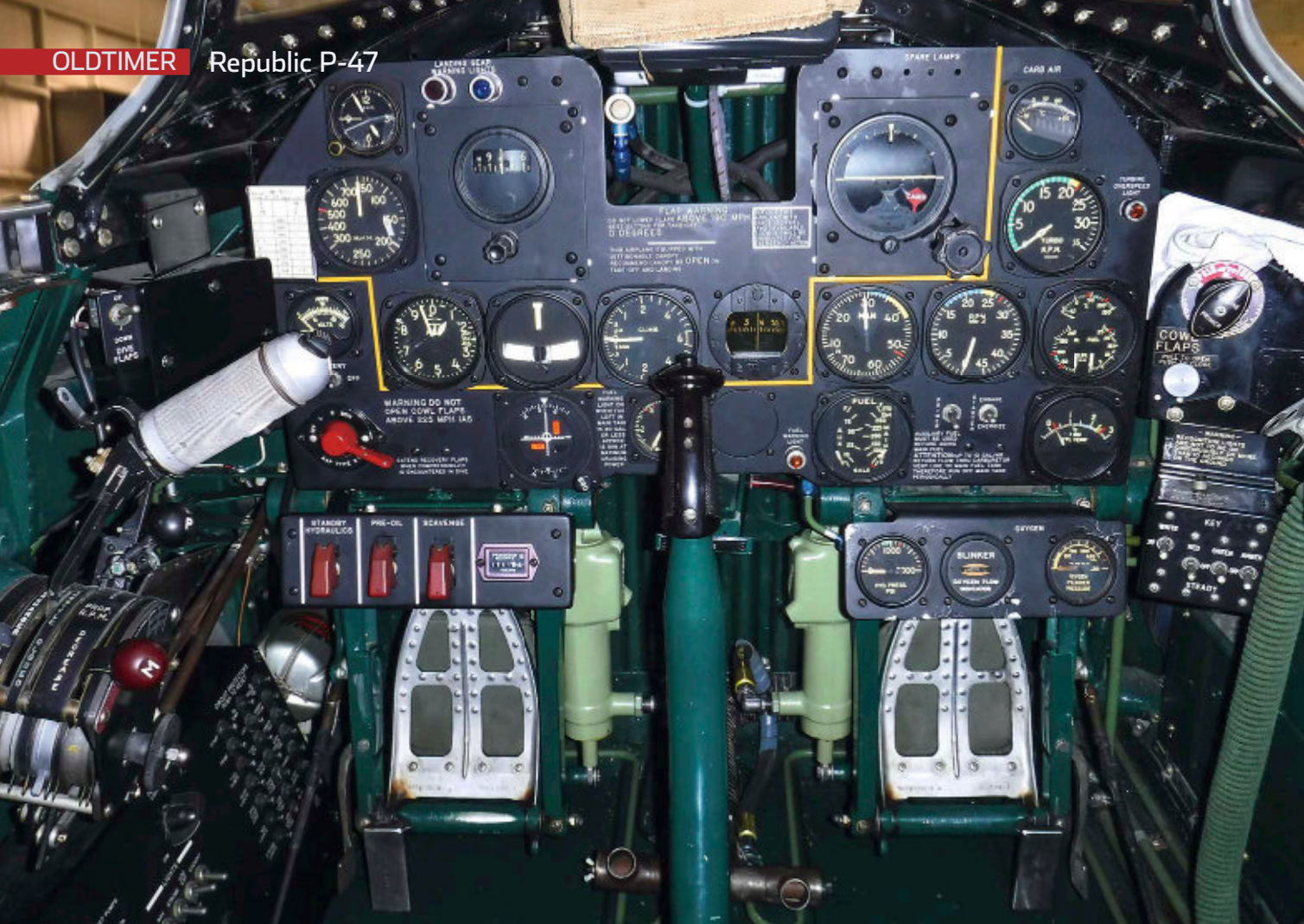
Das Cockpit der »HunHunter« befindet sich bis auf ein Navigationsinstrument und einen Flugstundenzähler im Originalzustand. Nach gut 1000 Flugstunden zeigen sich die ersten Abnutzungsspuren
