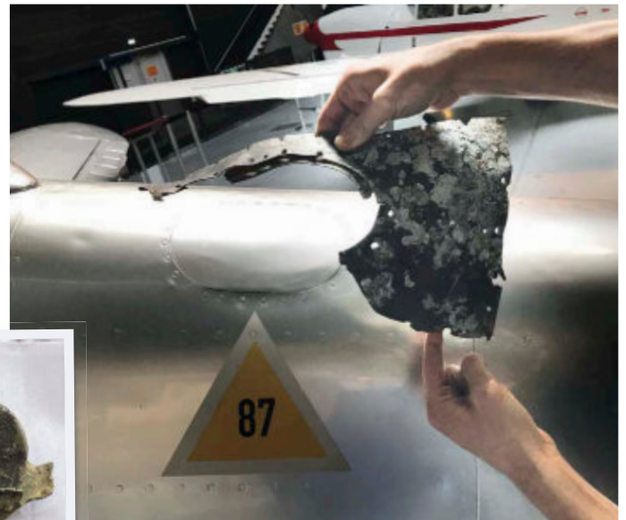
... der Rahmen eines Wartungsdeckels. Hier abgeglichen mit der Bf 109 im Aéroscopia Museum in Toulouse (siehe Seite 45 unten)
