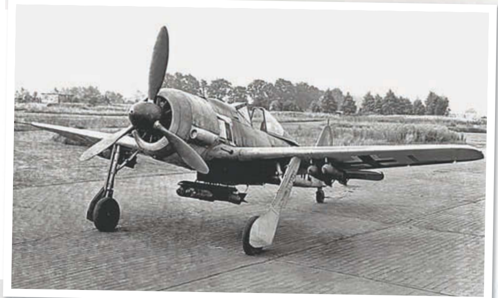
OBEN Die Fw 190 F-8 wurde zum leistungsfähigsten Schlachtflugzeug der Luftwaffe. Es konnte unter dem Rumpf 500-kg-Bomben tragen und unter den Tragflächen nochmals vier 50-kg-Bomben
