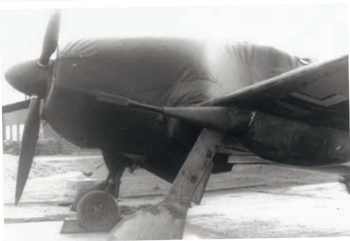
LINKS Die MK 103 mit Mündungsbremse und Laufabstützung
