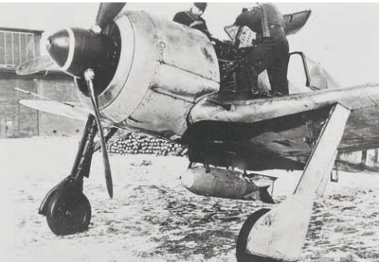
Bei eisigen Temperaturen müssen die beiden Waffenwarte diesen Fw-190-Jabo aufmunitionieren. Die 250-kg-Bombe ist bereits eingeklinkt
