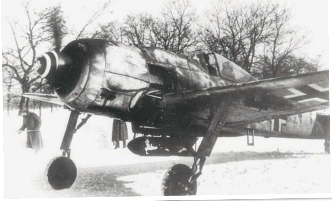
Startende Fw 190 F-8 an der Ostfront. Um genügend Bodenfreiheit zu haben und die Gängigkeit des Fahrwerks zu erhalten, hat man die Radverkleidungen teilweise entfernt
