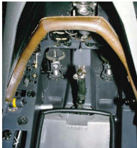
Die gepolsterte Geräteabdeckung enthält einen Ausschnitt für das Revi
