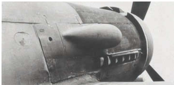
Der Jumo 213 erforderte für die Fw 190 eine neue Motorverkleidung samt außenliegender Laderhülse
