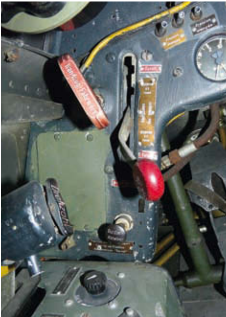
Brandhahn und Gashebel der französischen Fw 190 A-8. Das BG 25a fehlt. Die Hinweisschilder sind französisch Foto Philippe Couderchon (3)
