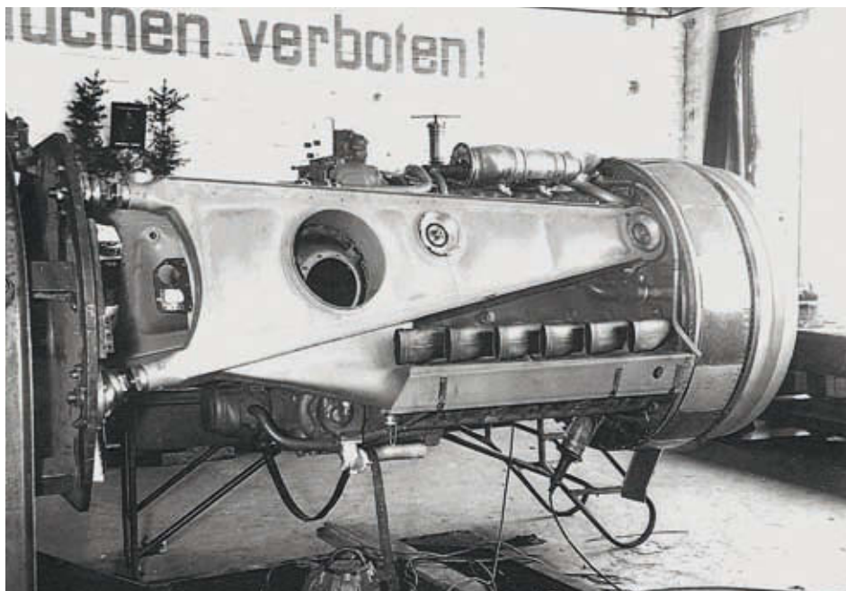
Zusammenbau des neuen Jumo 213 für die Fw 190 V17. Auffällig ist der wuchtige Motorträger
