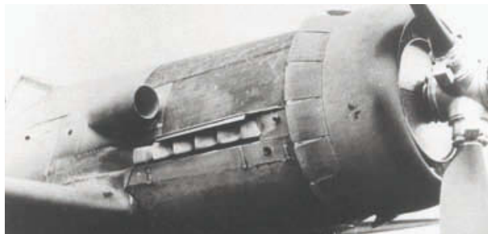
Der Jumo 213 erforderte für die Fw 190 eine neue Motorverkleidung samt außenliegender Laderhülse
