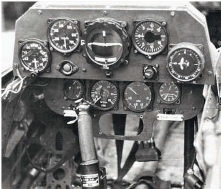
Hinteres Cockpit einer Fw 190 S-8. Das vordere Cockpit unterschied sich nicht von dem der A-8-Version
