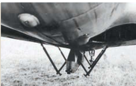
Detailansicht der Torpedoaufhängung von vorn. Von der Seite sieht man sehr gut, dass der Träger aus Holz und Metall entstanden ist
