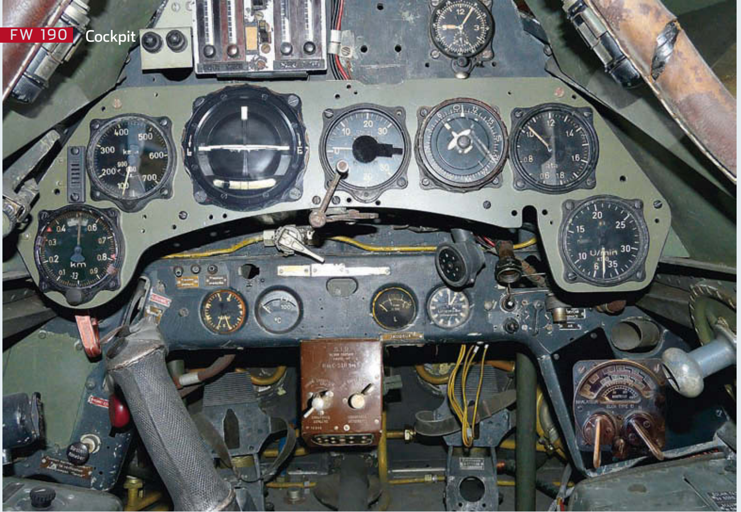
Cockpit der Fw 190 A-8 im Musée de l'Air. Die Instrumentierung ist noch weitgehend deutsch. Oben ist anstatt dem AFN 2 die Borduhr eingebaut. Die Sauerstoffanlage unten in der Mitte und rechts ist ein französisches Gerät
