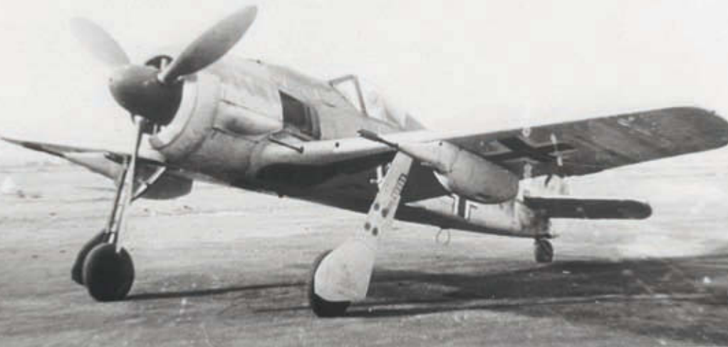
Die Fw 190 F-8 sollte mit zwei MK 103 als Schlachtflugzeug in der Konfiguration F-8/R3 dienen. Der Serienbau kam jedoch nie zustande
