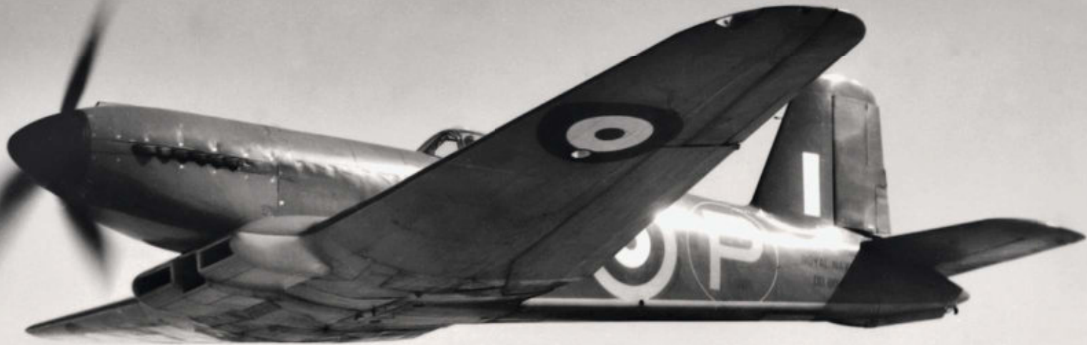
DD804 bleibt stets unbewaffnet. Zunächst dient sie aerodynamischen Versuchen und Leistungstests, ab Mai 1943 als Versuchsträger beim Motorenhersteller Napier in Luton Foto Blackburn/Sammlung Wolfgang Mühlbauer
