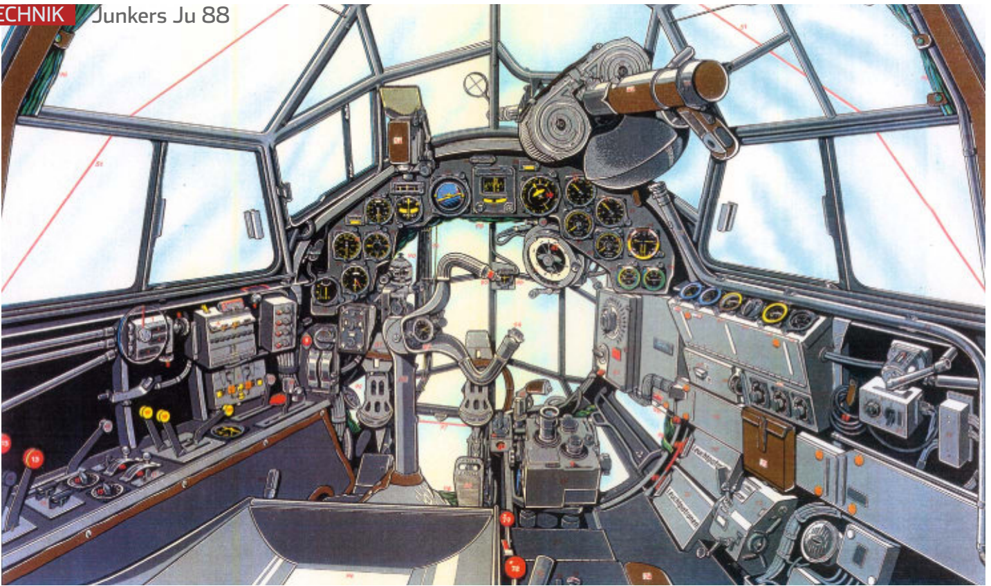
Arbeitsplatz des Flugzeugführers (links) und der etwas nach hinten rechts versetzte Sitz des Bombenschützen und Navigators mit den rechts angebrachten sechs Bombenabwurfgeräten
