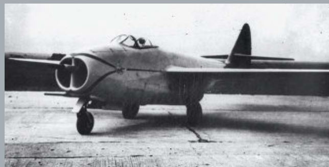
Der I-300-Prototyp war das allererste Jagdflugzeug mit Strahltrieb aus dem Hause MiG. Aleksej Nikolajewitsch Grinshik führte am 24. April 1946 den Erstflug der mit zwei BMW 003 A-1 ausgerüsteten I-300 durch
