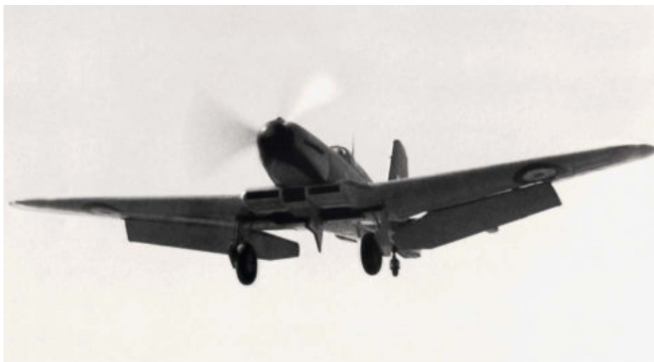
Großflächige Auftriebshilfen sind Markenzeichen der Firebrand – hier DD810 im Endanflug
