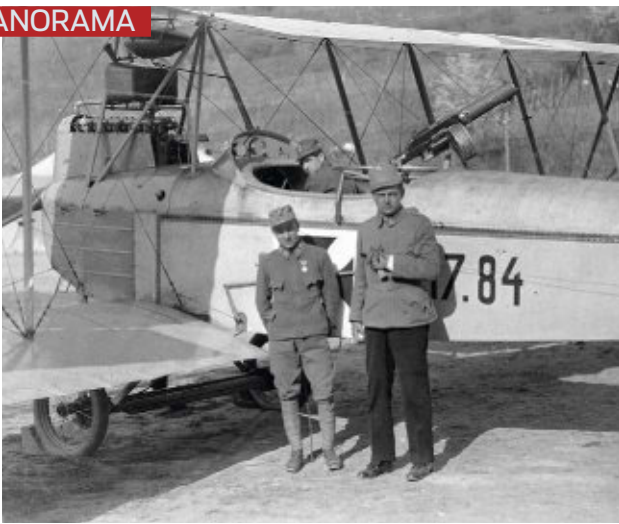
Die Lohner B.VII, ausgerüstet mit dem neuen Sechszylinder von Austro-Daimler. Mit diesem Flugzeug rückt der strategische Angriff auf Mailand in den Bereich des technisch Möglichen
