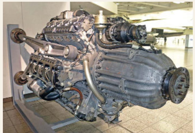
50-Liter-Aggregat Jumo 222 E im Deutschen Museum in München. Der 24-Zylinder-Motor erfüllte die Leistungsanforderungen, die für den sicheren Betrieb des P 195 nötig gewesen wären
