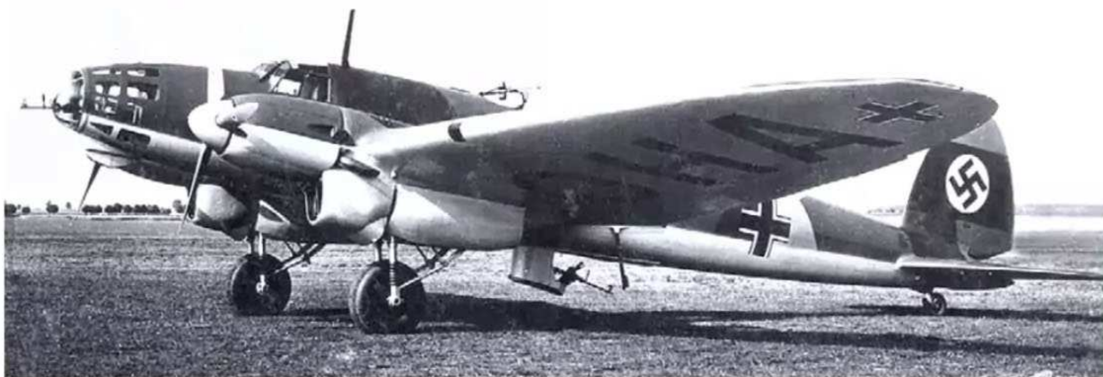
Frühe He 111 D mit DB 600, der jedoch nicht in ausreichender Stückzahl zur Verfügung stand
