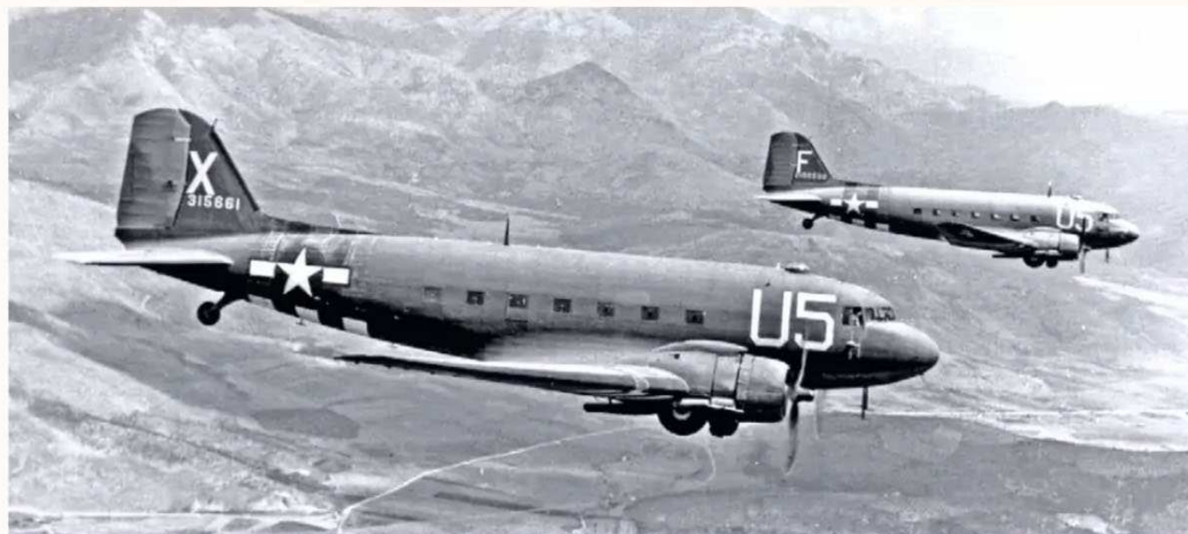
Alliiertes Gegenstück zur Ju 52/3m: Douglas C-47 Skytrain der 12th Air Force Troop Carrier Wing im Sommer 1944 über Frankreich. Konstruktiv trennten die C-47 fünf Jahre von der Ju 52 – Lichtjahre im damaligen Flugzeugbau
