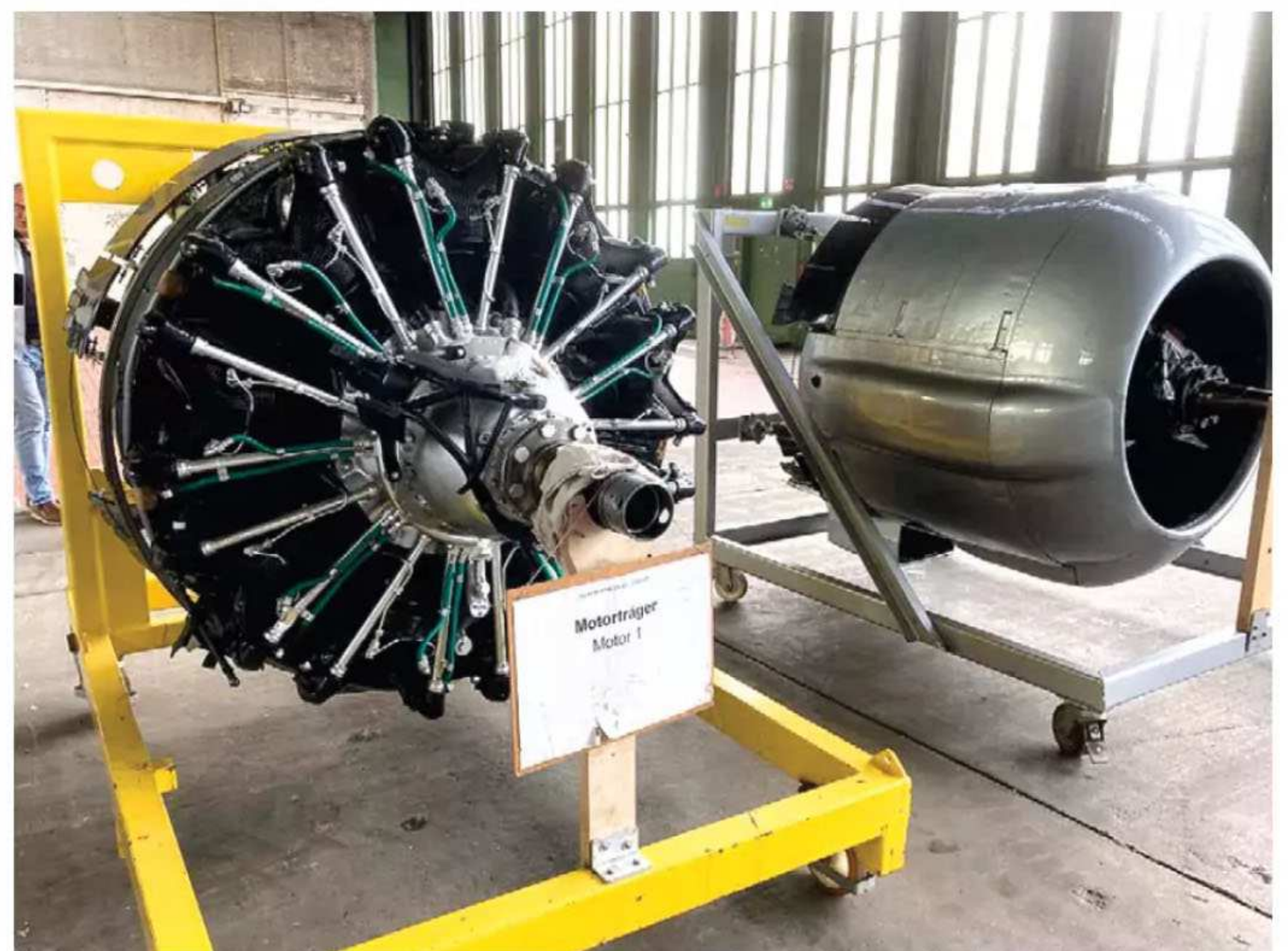
Die bei Rolls Royce in Oberursel von engagierten Mitarbeitern restaurierten Motoren der Fw 200 vom Typ Bramo 323 R2, in Transportgestellen aufgebockt und bereit für die Montage
