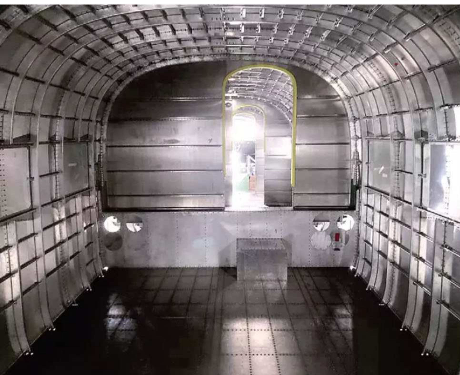
Betritt man die Fw 200 durch die linke Tür, zeigt der Blick nach vorne, dass der Rumpf in mehrere Sektionen aufgeteilt ist. Wie sorgfältig alles verarbeitet ist, springt dabei sofort ins Auge
