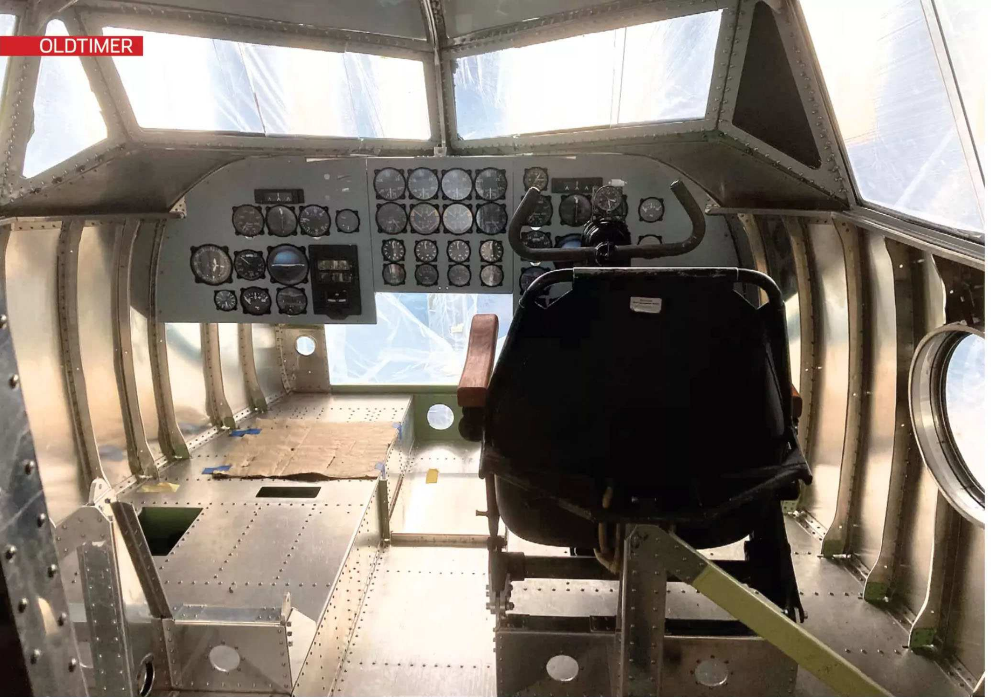
Das teilrestaurierte Cockpit mit Sitz und Steuer für den Copiloten. Die Instrumente sind als dreidimensionale Displays den Originalen nachempfunden
