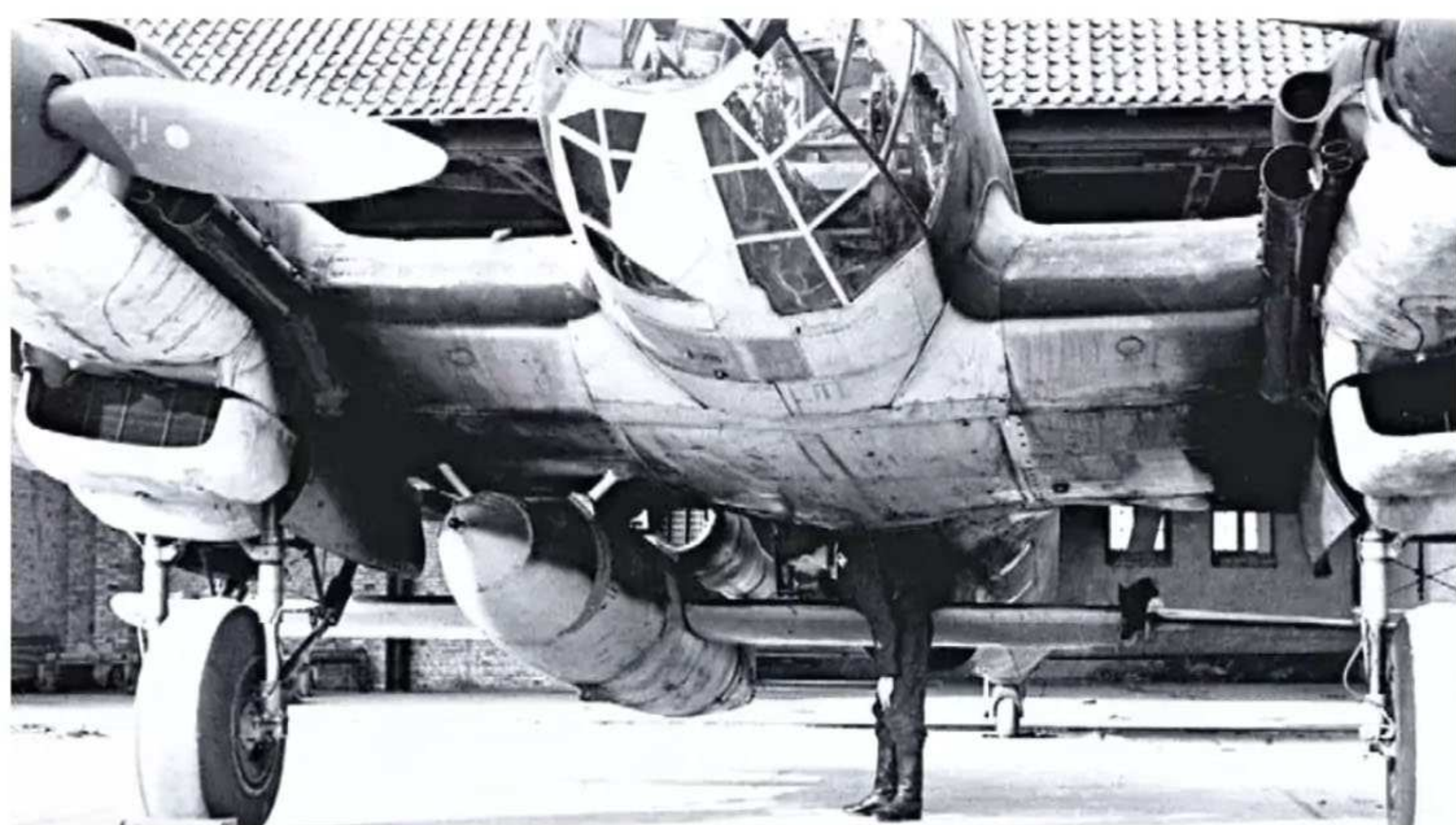
Eine einsatzklare Heinkel He 111 H-16 der 3. Staffel des KG 53. Die Fi 103 hängt fertig angeschlossen am Träger PVC 1006, so nah wie möglich an der Längsachse des Kampfflugzeugs
