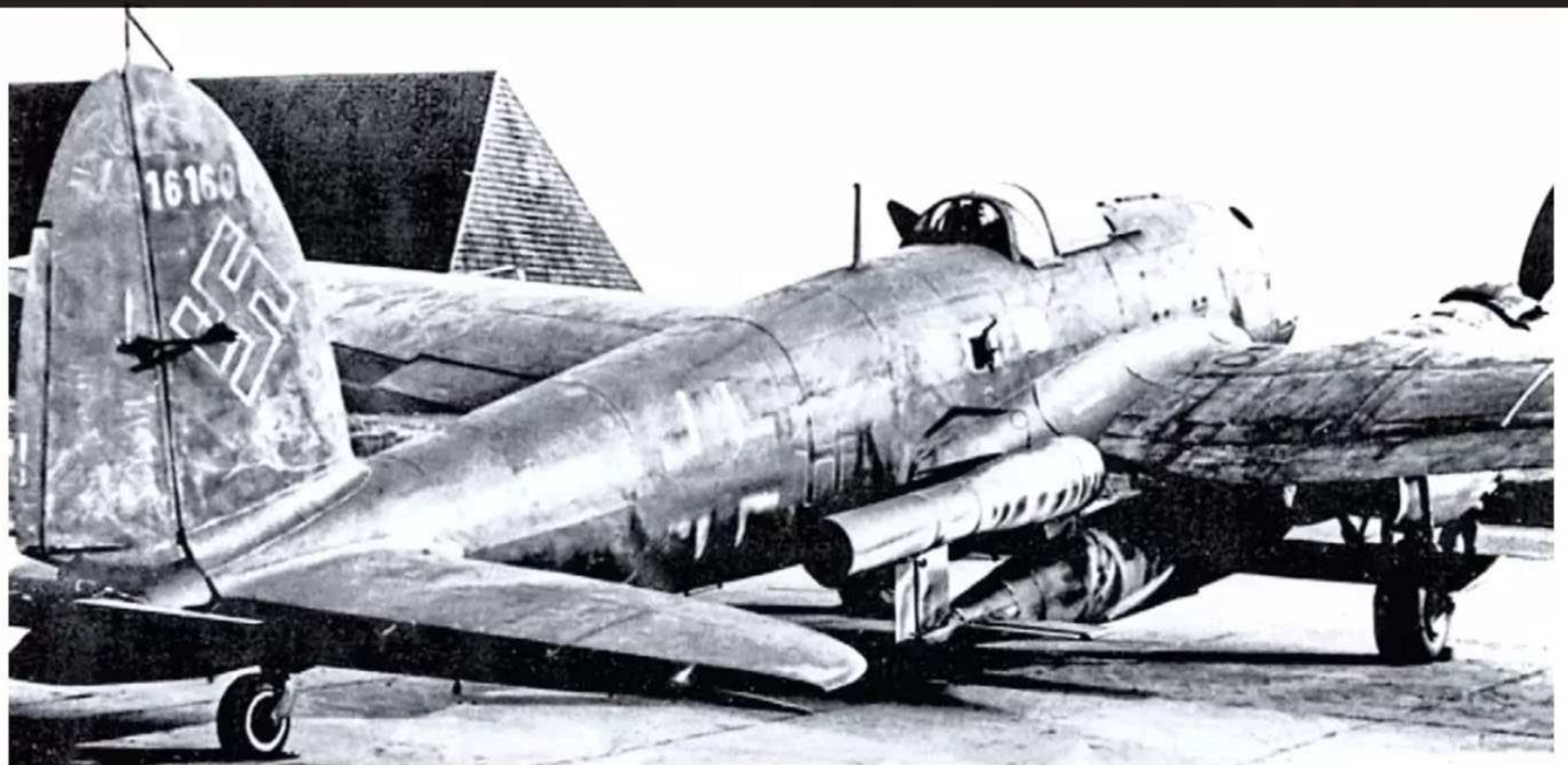
He 111 H-16, W.Nr. 161600, A1+HK, der 2./KG 53 mit FZG 76 im Oktober 1944. Unten: Während der Erprobungsphase an einer He 111 H – hier auf der linken Seite untergehängt
