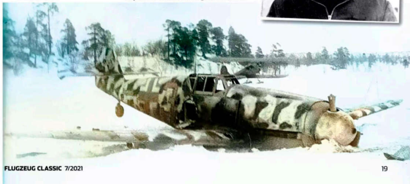
Rudolf Müllers abgeschossenes Flugzeug nach der Notlandung auf dem Eis – seine Messerschmitt Bf 109 G-2/R-6, W.Nr. 14 810, war für die sowjetischen Streitkräfte von großem Interesse
