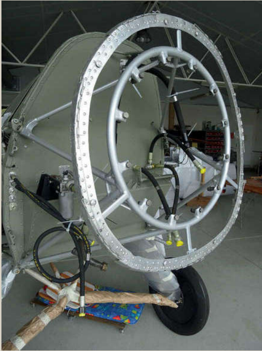
Bei der »2896« prangte 2019 schon der Brandspant vor dem Rumpf, ebenso der Motorträger für ...
