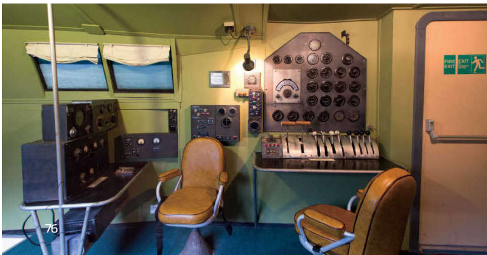
In Flugrichtung links saß der Navigator, rechts neben ihm der Bordfunker und dahinter der Bordingenieur
