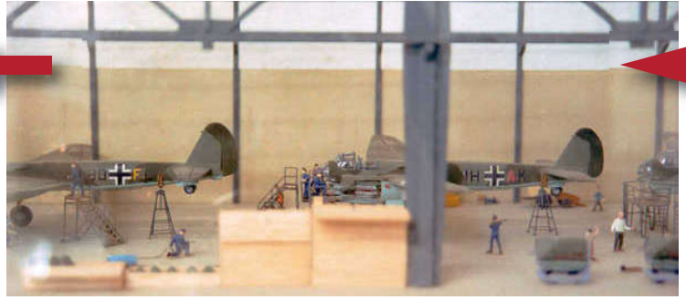
Dieses Hallenmodell im Bernburger Museum zeigt die einzelnen Takte in der Ju-88-Endmontage: Im ganz rechten Bild beginnt die Endmontage mit dem Ansetzen der Flügel, dann rückt das Flugzeug weiter nach vorn, bis es fertiggestellt im ganz linken Bild aus der Halle zum Kompensieren rollt
