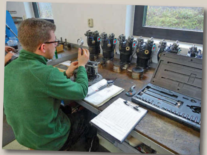
Präzision und Genauigkeit sind bei jedem noch so kleinen Teil extrem wichtig: Max Bick vom Bende-Team überprüft, vermisst und dokumentiert hier die Zylinderköpfe
