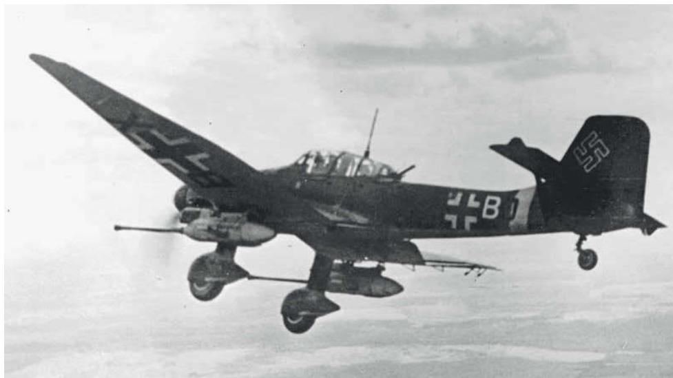
Die Ju 87 G mit zwei 3,7-cm-Flak 18 unter den Tragflächen und dem MG 81 Z im Heckstand war auch als »Kanonenvogel« und »Panzerknacker« bekannt. Sie sollten beim Unternehmen »Zitadelle« die Masse der sowjetischen Tanks aufhalten, aber es gab nur wenige von ihnen Foto p-a/ZB
