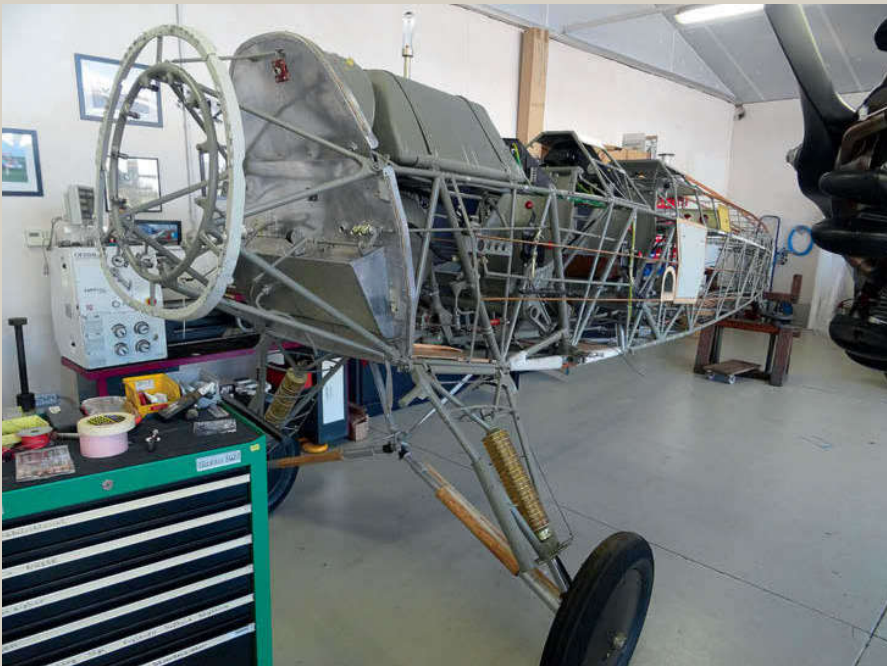
Bereits bearbeitetes und neu lackiertes Rumpfergüst der »2775«. Hier hatte die Mannschaft von LTB Bende schon ordentlich Arbeit geleistet und einige Anbauten ergänzt
