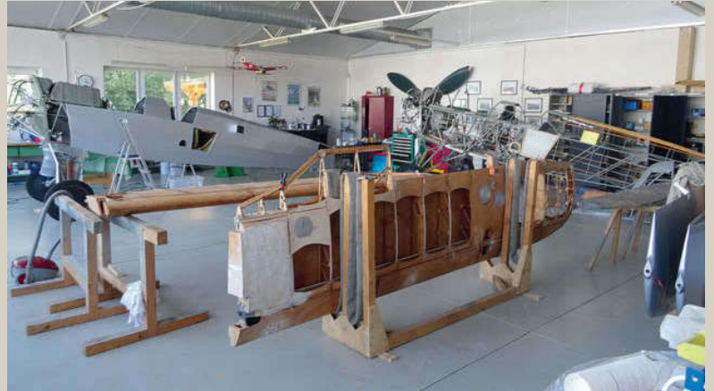
Links die 2019 bereits weit vorangeschrittene Fw 44, W.Nr. 2896, rechts der »2775« noch als Gerüst. Davor die bearbeiteten Holzflächen
