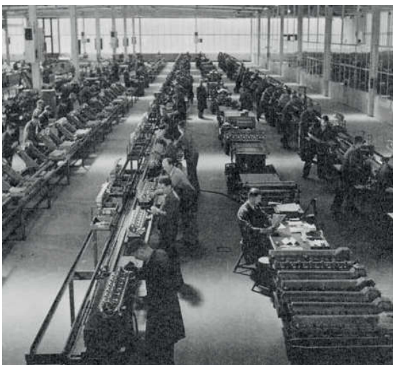
Motorenproduktion Jumo 211B in Köthen 1938: Links die sogenannte Gruppenbandmontage, rechts legen die Arbeiter Hand an die Gehäuse, die am Band vorbeilaufen
