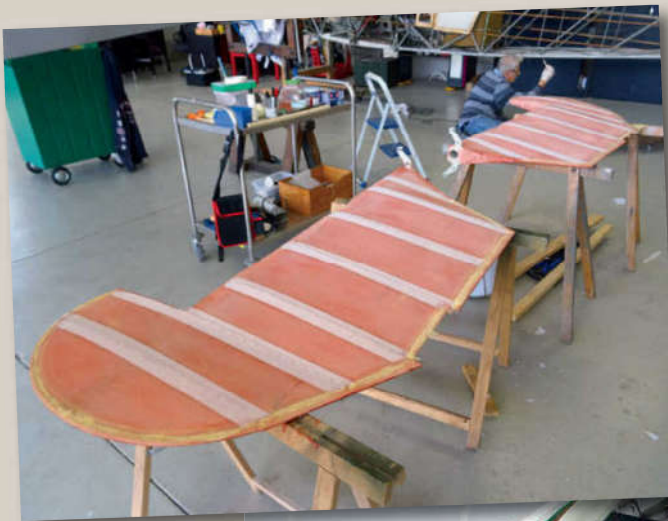
Die Höhenruder hat das Team bespannt und mit einem UV-Schutzlack versehen
