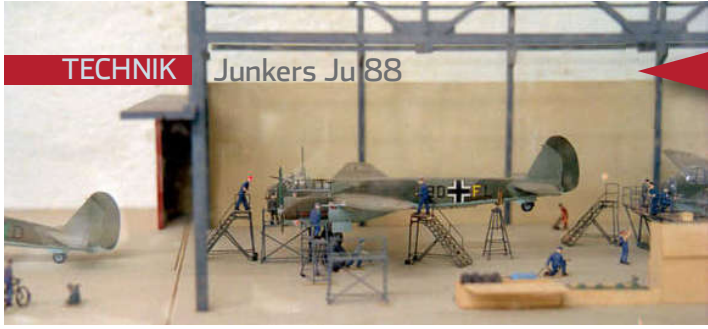
Dieses Hallenmodell im Bernburger Museum zeigt die einzelnen Takte in der Ju-88-Endmontage: Im ganz rechten Bild beginnt die Endmontage mit dem Ansetzen der Flügel, dann rückt das Flugzeug weiter nach vorn, bis es fertiggestellt im ganz linken Bild aus der Halle zum Kompensieren rollt
