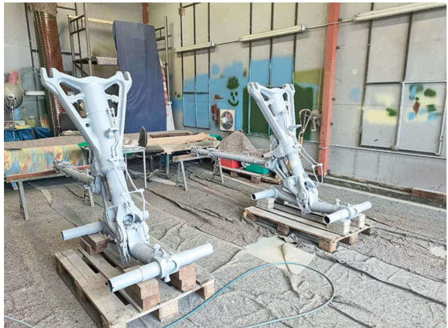
Das frisch restaurierte Fahrwerk soll bald wieder mit der Tu-134 vereint sein
