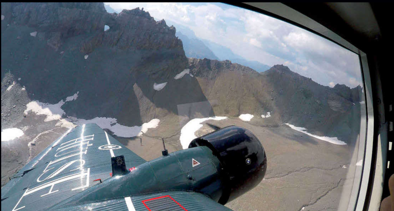
Sekunden vor dem Drama hat ein Passagier aus der HB-HOT das Martinsloch in den Tschingelhörnern auf einer Höhe von 2724 Metern fotografiert. Die Ju 52 besaß zu diesem Zeitpunkt eine beängstigende Querlage von 32,7 Grad Foto SUST
