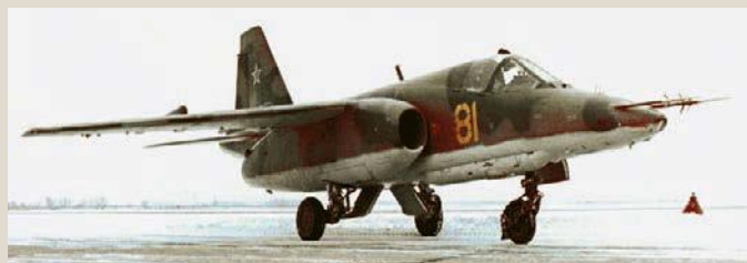
Der erste Prototyp T-8-1 »Gelbe 81« war noch mit einem kurzen Seitenleitwerk ausgerüstet
