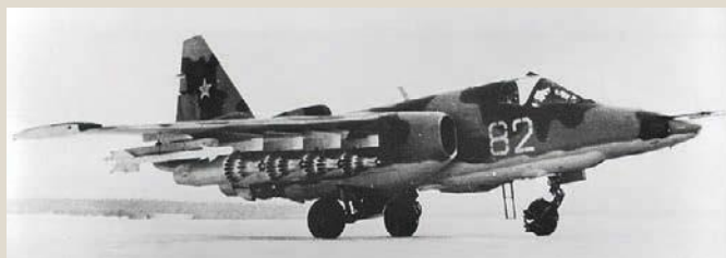
Am zweiten Versuchsmuster T-8-2 »Blaue 82« war die 30-mm-Kanone AO-17A zu Beginn in einer Gondel untergebracht
