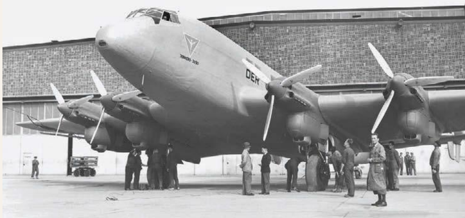
Die Junkers Ju 90, »Der große Dessauer« war ihrer Zeit voraus – hier die Ju 90 V1 mit DB-600-A-Motoren, die am 28. August 1937 erstmals flog
