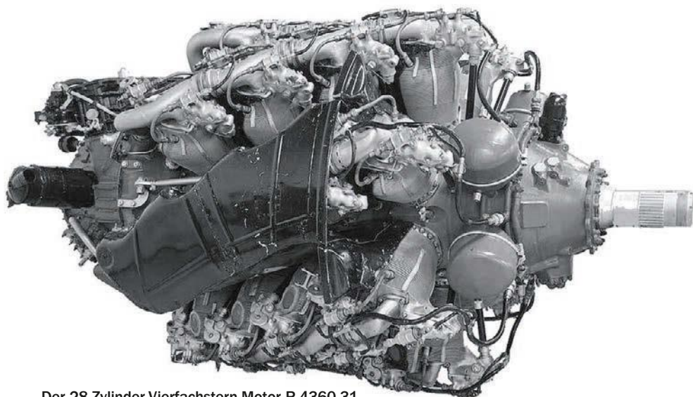
Der 28-Zylinder-Vierfachstern-Motor R-4360-31 von Pratt & Whitney kam in der XF-11 zum Einsatz. Er hatte sich in der Boeing B-29 Superfortress bereits bewährt Foto Alan Wilson
