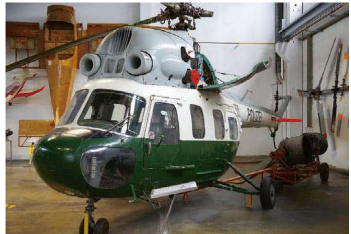
Der sowjetische Mehrzweckhubschrauber Mi-2 aus polnischer Produktion kam bei der Polizei der DDR zum Einsatz
