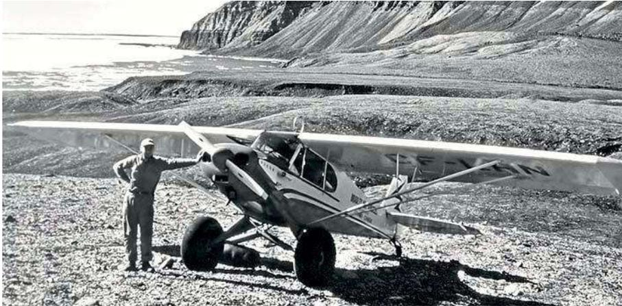
... die gewaltigen »Tundra«-Reifen von Buschflugzeugen auf ein Patent aus dem Jahr 1929 zurückgehen und die Firma Goodyear sie bald darauf mit bis zu 117 Zentimetern Durchmesser herstellte?
