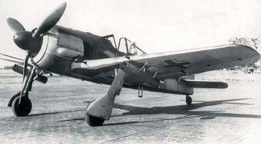
Die Fw 190 erhielt speziell für den Kampf gegen Bomber zwei Abschußrohre für die WGr. 21
