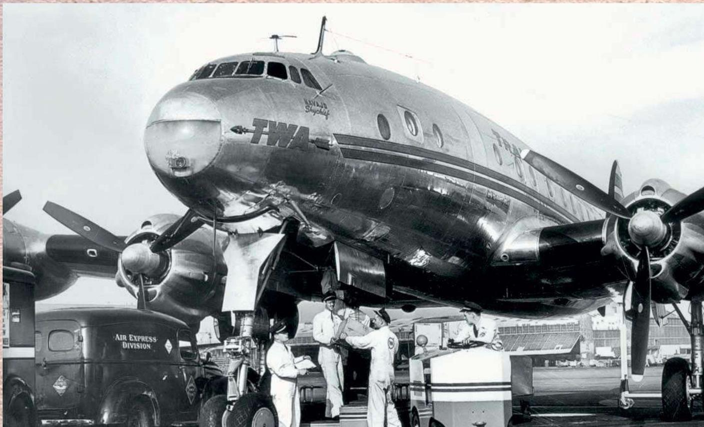
Deutlich zu erkennen: Das Astrodome im Dach des Vorderrumpfes dieser L-049 der TWA. Derartige Navigationskuppeln kamen bereits während des Zweiten Weltkriegs zum Einsatz
