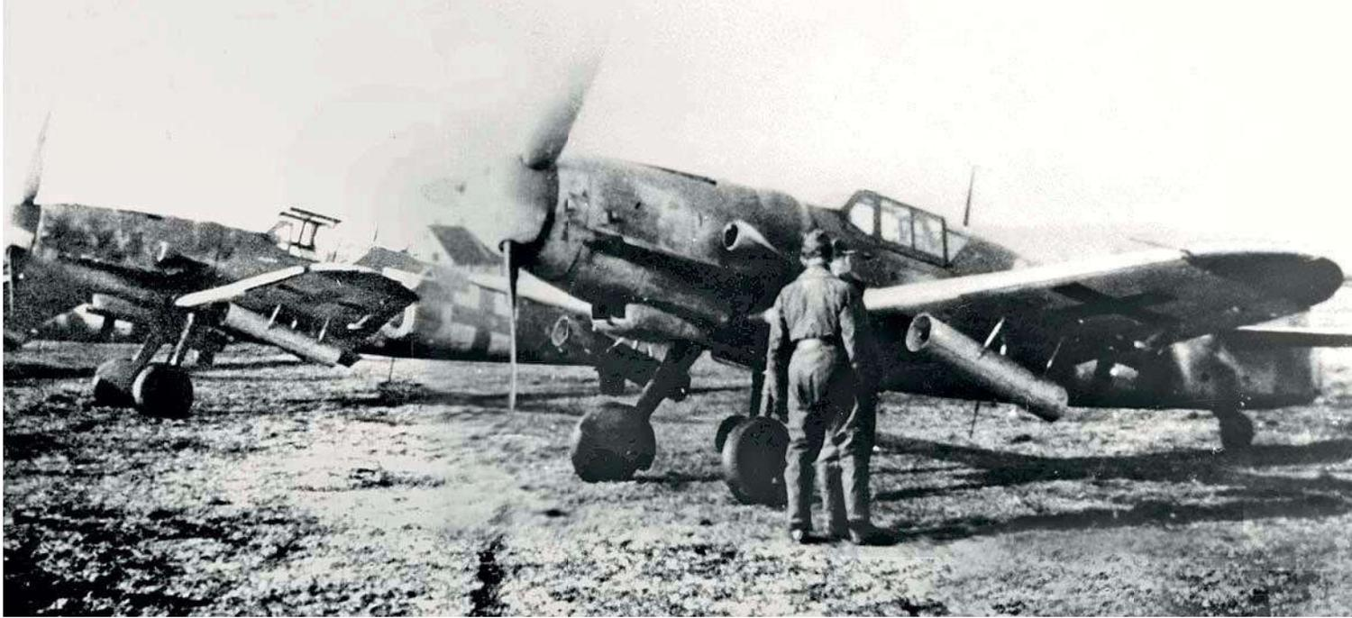
Bf-109-G-6-Jäger mit geladenen Werferrohren stehen für den nächsten Einsatz bereit. Im Fliegerjargon hießen die wuchtigen Rohre passenderweise »Dödel«
