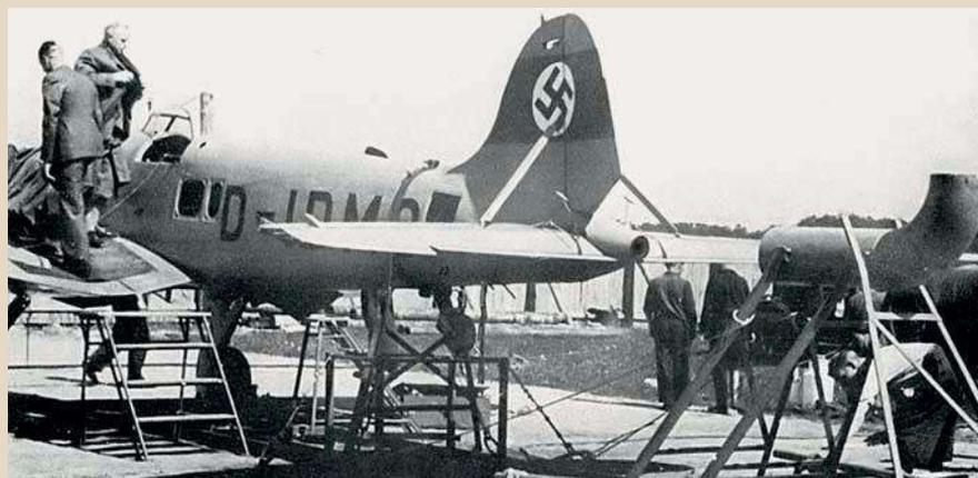
Die mit Raketentriebwerk versehene He 112 R/V3, W.Nr. 1292, D-IDMO, während eines Testfluges. Höhen- und Seitenleitwerk stabilisierte man durch Streben
