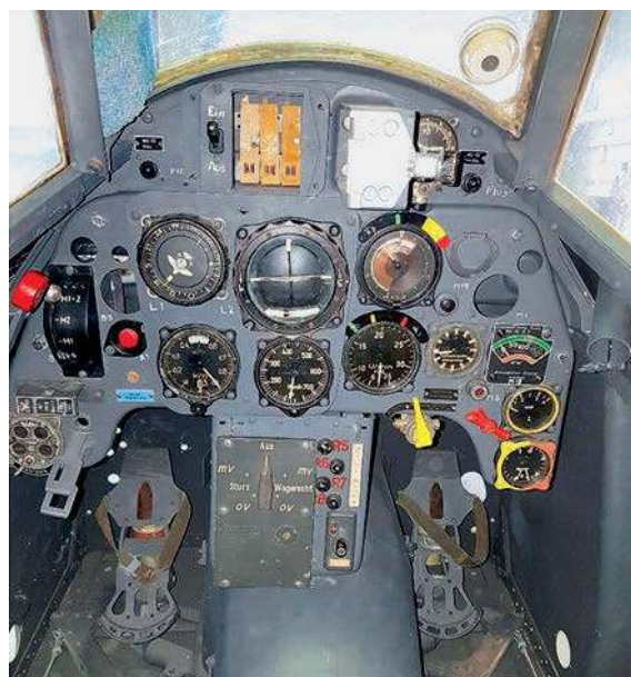
Das Hauptgeräte Brett der Bf 109 G-2 kurz vor dem Finale. Einzelne Instrumente fehlen noch
