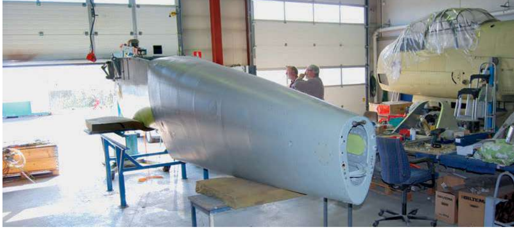
Sogleich ran ans Werk, aus dem Wrack muss wieder ein Flugzeug werden: hintere Rumpfpfütze und Führerraum im Bau
