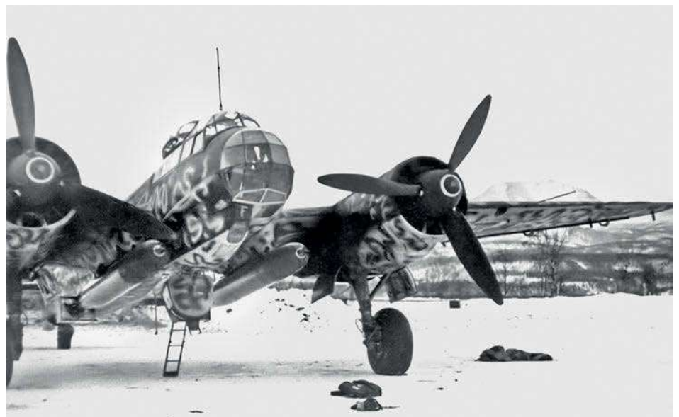
Einsatzklare, mit Torpedos des Typs LT 5b bestückte Junkers Ju 88 A-4/Torp der I. Gruppe des KG 26
