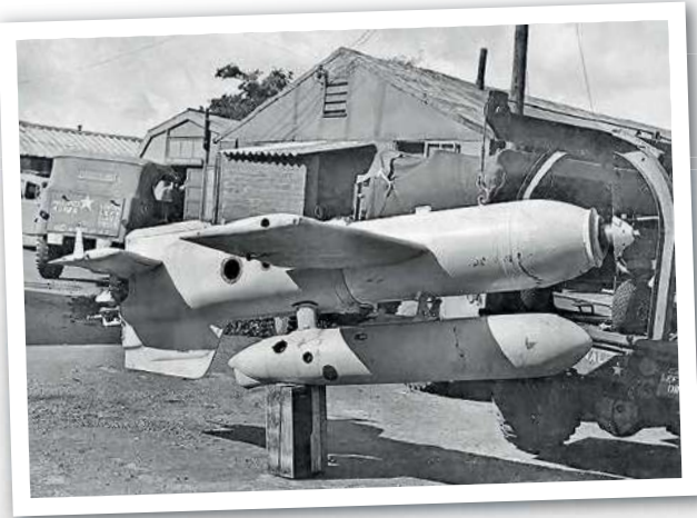
Damals ein hochmodernes, wertvolles US-Beutestück: Henschel Hs 293. Die 975 Kilogramm schwere Gleitbombe war bis zu 950 km/h schnell und trug einen 660-kg-Gefechtskopf
