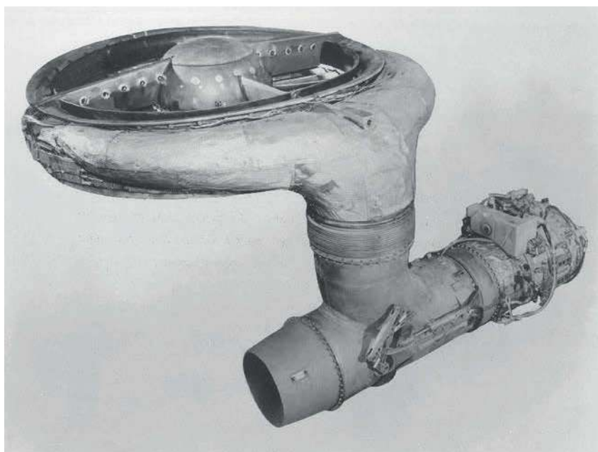
Musteraufbau eines General Electric J85-GE-5-Turbojets mit X353-5-Fangebläse, um den kalten Massenstrom abzuleiten
