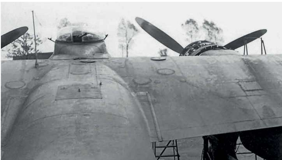
Blick auf den B-Stand einer Do 217 E mit Drehturm DL 131, bestückt mit einem 13-mm-MG 131. Links und rechts ragen MG-15-Läufe aus dem hinteren Teil der Kabine
