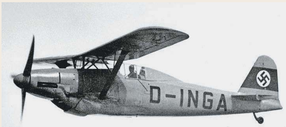
Als abgestrebter Hochdecker kam Focke-Wulfs Fw 159 nicht an die Flugleistungen der freitragenden Tiefdecker heran. Große Schwierigkeiten mit dem instabilen Einziehfahrwerk taten ein Übriges
