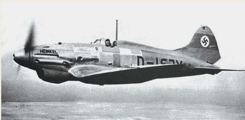
Vorserienmaschine He 112 A-0, D-ISJY. Typisch für die frühen »112« sind der große Kinnkühler und die weit nach vorne gezogene Seitenflosse
