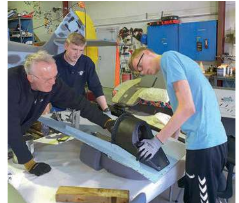
Ketil Lunde hilft den Studenten Isak Selbekk and Andreas Grostad Vilhelmsen von der Bodø Aircraft Mechanics Akademy bei der Restaurierung einer MG-151/20-Gondel
