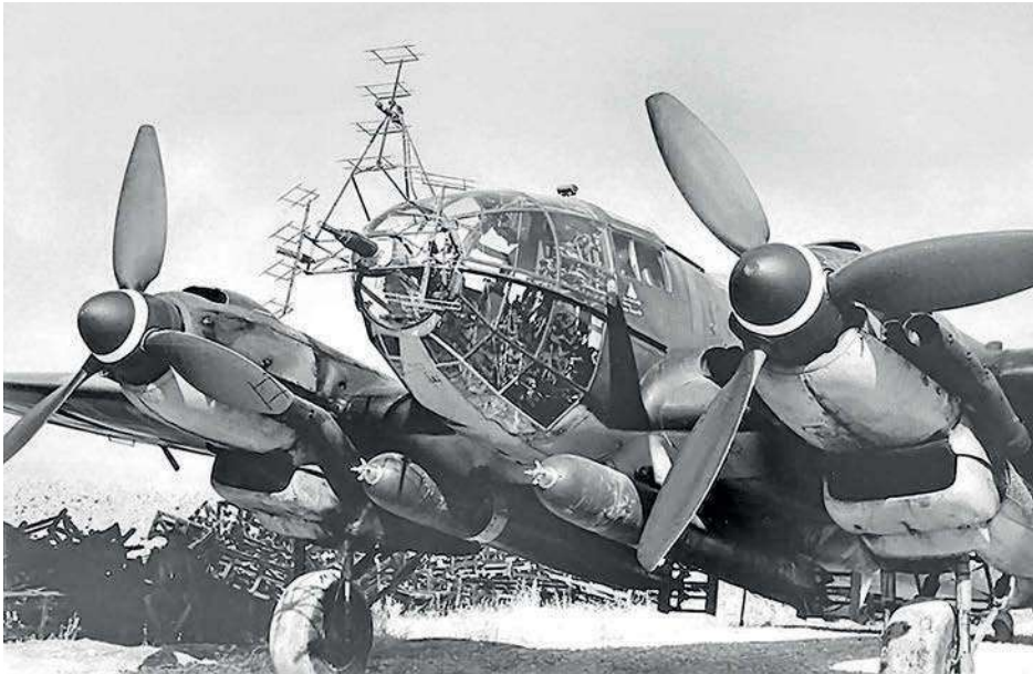
Torpedobomber He 111 H des KG 26, ausgerüstet mit dem zur Schiffsortung ausgelegten Funkmessgerät FuG 200 »Hohentwiel«. Kalmbach und seine Kameraden hatten keinen Radar
