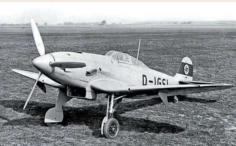
He 112 V9, W.Nr. 1944, D-IGSI, war ein Musterflugzeug für die Serienversion E. Die große Spurweite garantierte hohe Stabilität am Boden, der Kühler ließ sich aus- und einfahren (siehe auch Zeichnung Seite 57)
