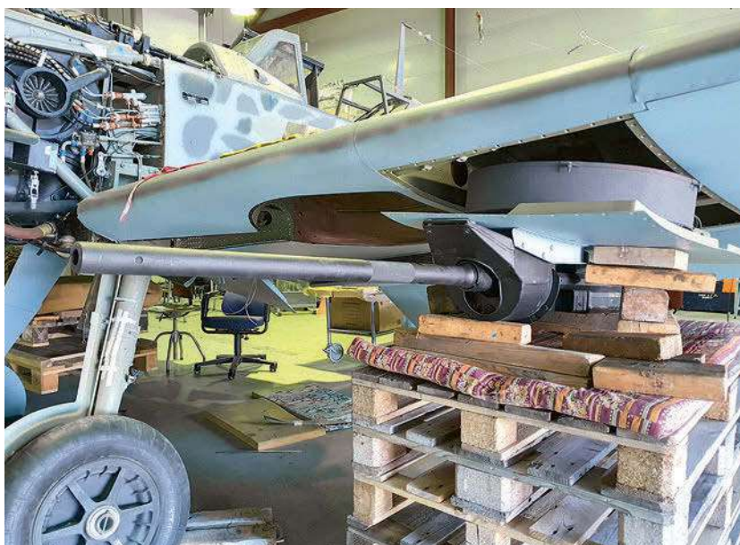
Einbau der MG 151/20 in den Tragflächen. Zwar war die W.Nr. 14 649 bei ihrem Absturz nicht mit Unterflügel gondeln ausgerüstet, trug sie aber vorher zeitweise
