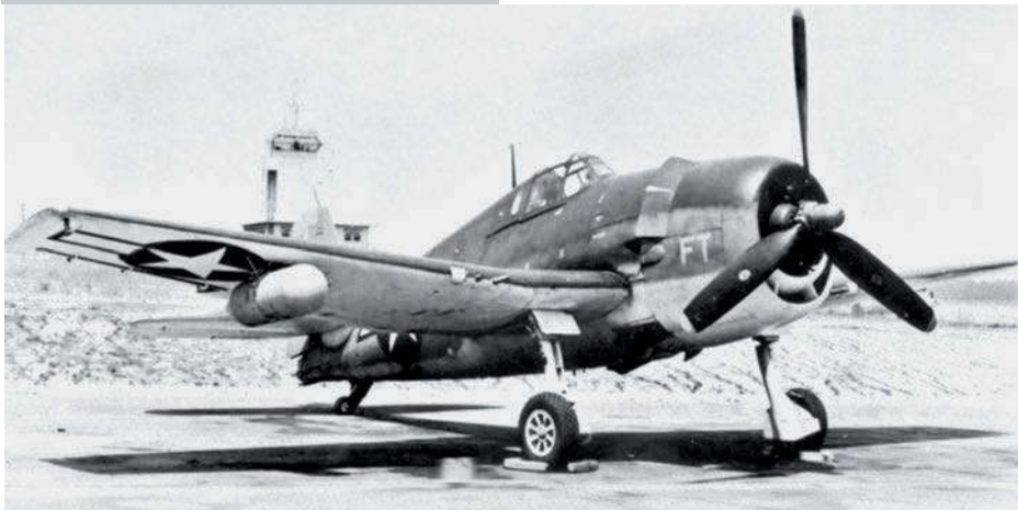
Von der Grumman F6F-3E mit AN/APS-4-Radar entstehen insgesamt 18 Stück. Bis Ende 1943 sind sie ausgeliefert
