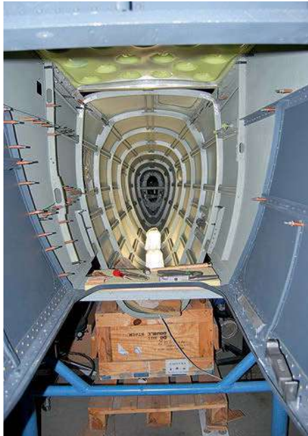
Blick von innen in die hintere Rumpfpfütze. Damit die Restaurateure es einfacher haben, steht die Zelle auf dem Kopf
