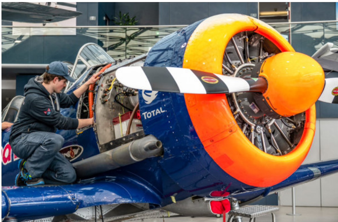
Einblick An der AT-16 führt Jakob eine visuelle Kontrolle des Brandschotts durch. Die Maschine wurde von Walter Eichhorn übernommen
