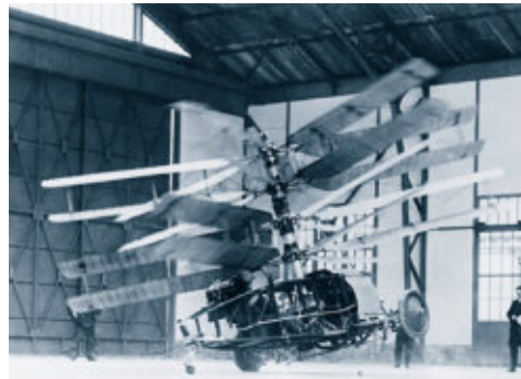
Wilde Kiste Raul Pescaras Koaxial-Hubschrauber hat vier gegenläufige Rotoren. In einem Hangar bei Paris macht er seine ersten Flugversuche
