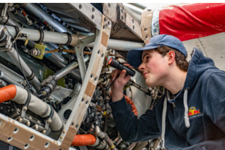
Bis ins Detail Am Backbord-Triebwerk der P-38 Lightning checkt der Azubi die komplexe Technik des Allison V1710, eines flüssigkeitsgekühlten V12
