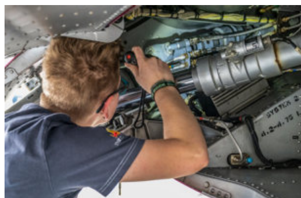
Inspektion Kathrin ist in den Fahrwerksschacht eines Alpha Jets gekrochen, um die Hydraulik auf Leckage zu prüfen
