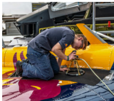
Luft rein Im Rahmen der Depot-Inspektion werden die Tanks eines Alpha Jets mit Druck beaufschlagt
