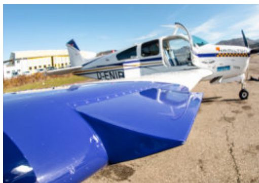
Hilft beim Trudeln Der dreieckige Anbau verbessert die Anströmung der Querruder bei manchen Kunstflugmanövern
