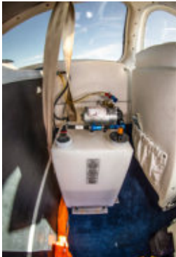
Vorführ-Effekt Im Gepäckraum verbirgt sich der Rauchöl-Tank samt Pumpe. Das Öl wird in den Auspuff gespritzt und verbrennt dort
