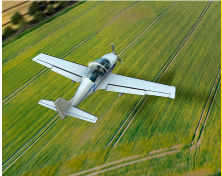
Volle Klappen und Mindestfahrt Für den zweckentfremdeten Untergrund ist das Flugzeug auf Softfield-Landung konfiguriert. Aufgesetzt wird so weich und so langsam wie möglich. Je härter der Untergrund, desto stärker kann der Pilot bremsen
