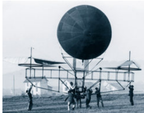
Hybrid-Helikopter Etienne Oehmichen lässt bei seiner No. 1 die Hälfte des Auftriebs von einem Gasballon erzeugen, der Rest kommt von zwei Rotoren
