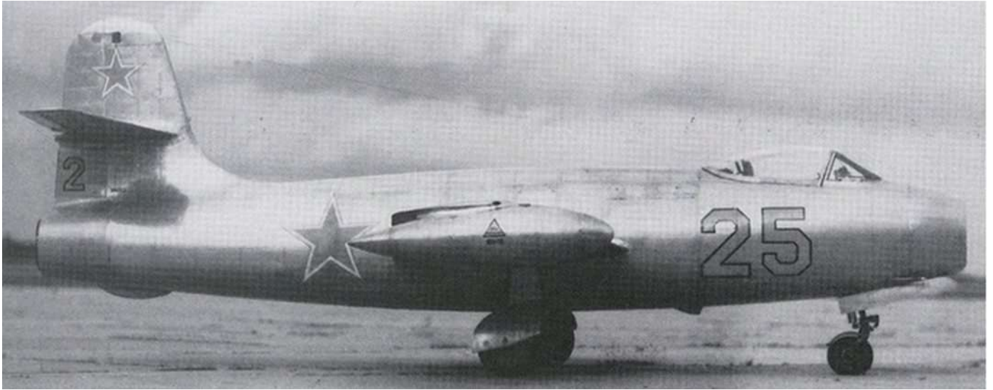
Das zweite Testflugzeug Jak-19-2 wurde mit Kraftstoffzusatzbehältern an den Tragflächenenden ausgerüstet.
