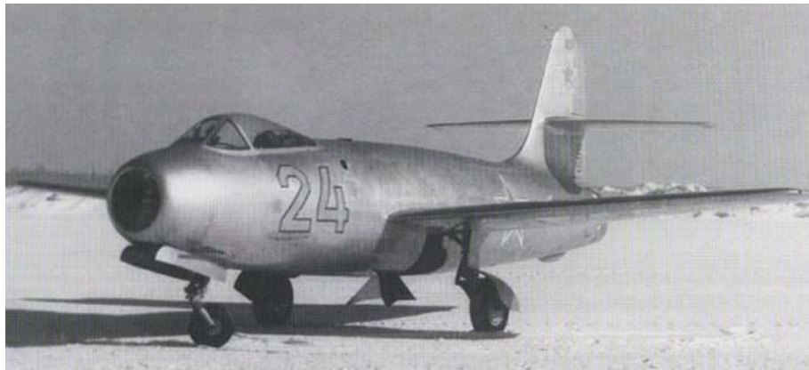
Experimentalflugzeug Jak-19-1 während der Werkserprobung, wichtigstes Ziel der Erprobung war die Nutzung eines Nachbrenners im Flug.
