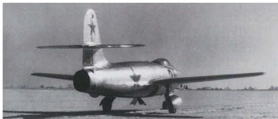
Der Nachbrenner brachte einen beträchtlichen Schubzuwachs. Der damit erreichte Geschwindigkeitszuwachs entsprach letztendlich nicht mehr den Forderungen.
