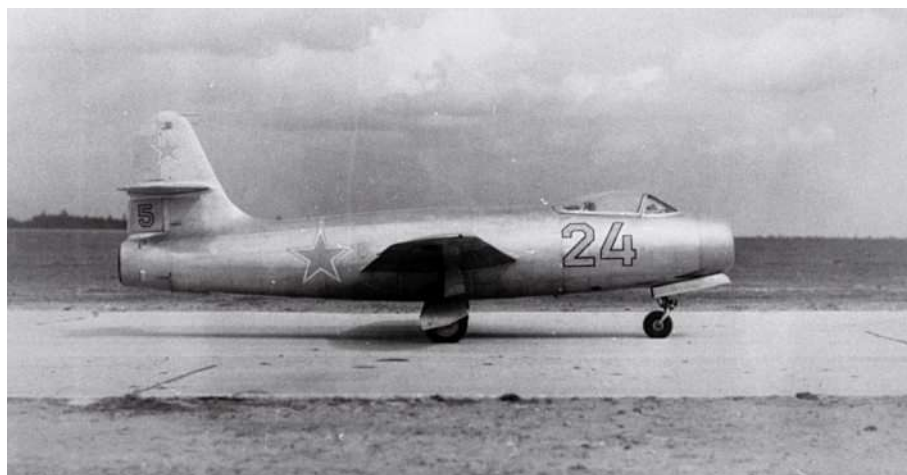
Die Konstrukteure bauten erstmalig im OKB Jakowlew das Strahltriebwerk in den Rumpf ein.
