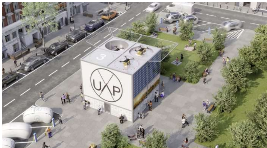
Die von UAP entwickelte City Box dient der Integration von unbemannten Liefer-Drohnen in den Warentransport. Die Drohnen werden automatisch entladen und Kunden können sich ihre Ware in Schließfächern abholen.
