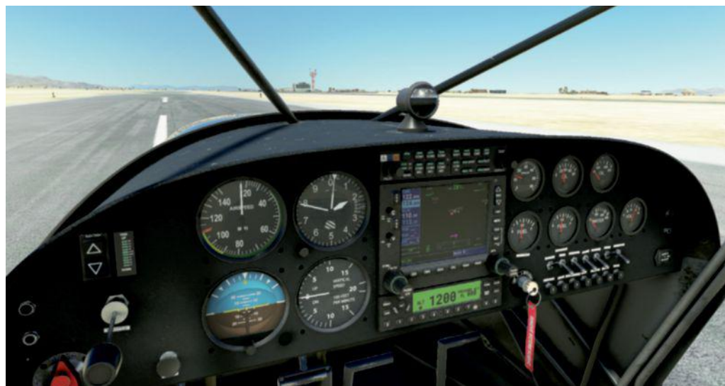
Das einfach gehaltene Panel mit Standard-GN6 530 ist leicht zu bedienen.
