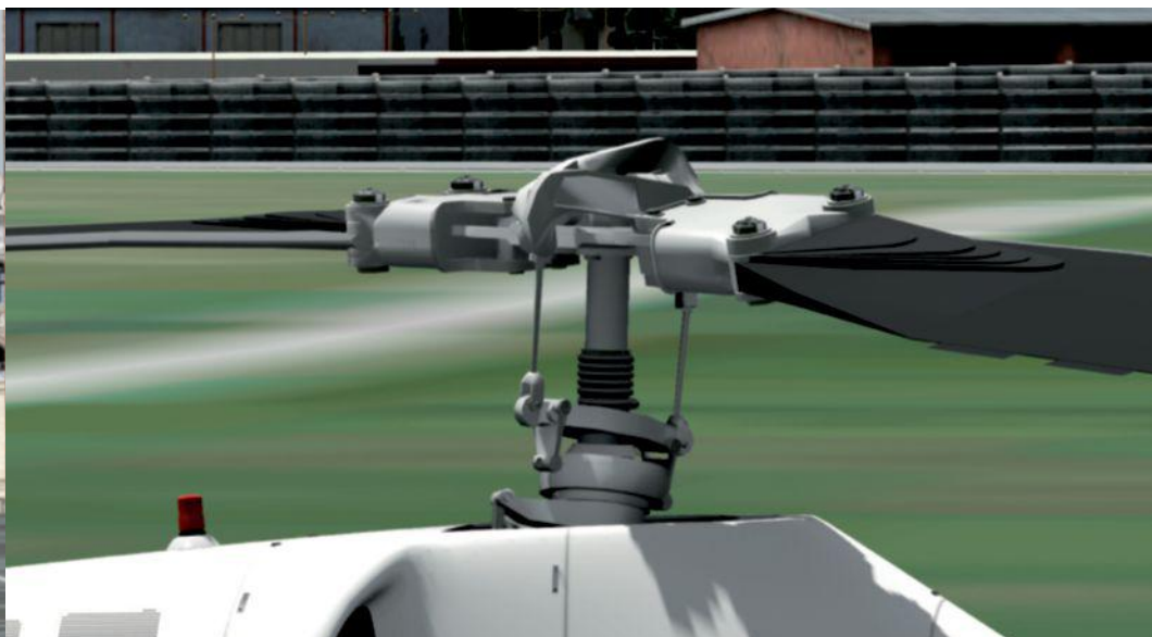
Großes Kino bietet die detaillierte Taumelscheibe der Bell 222.
