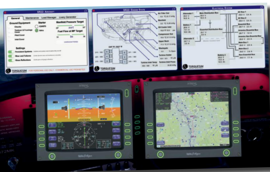
Gut lesbare Pop Ups bei der SR20 und SR22 Entegra: Systemdiagramme, PFD und MFD.
