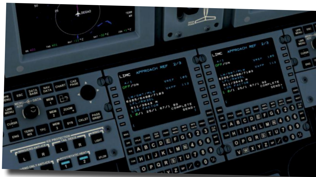
Die beiden CDUs der CJ4 mit den Cursor Control und Anti Ice Panels daneben.
