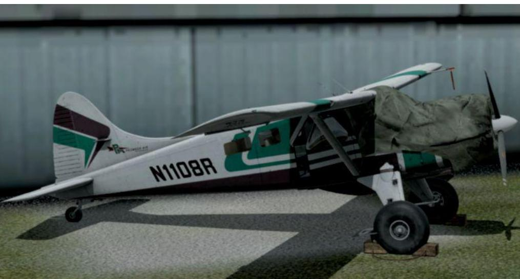
Motor und Cockpitscheibe lassen sich am Boden mit einer Plane schützen.
