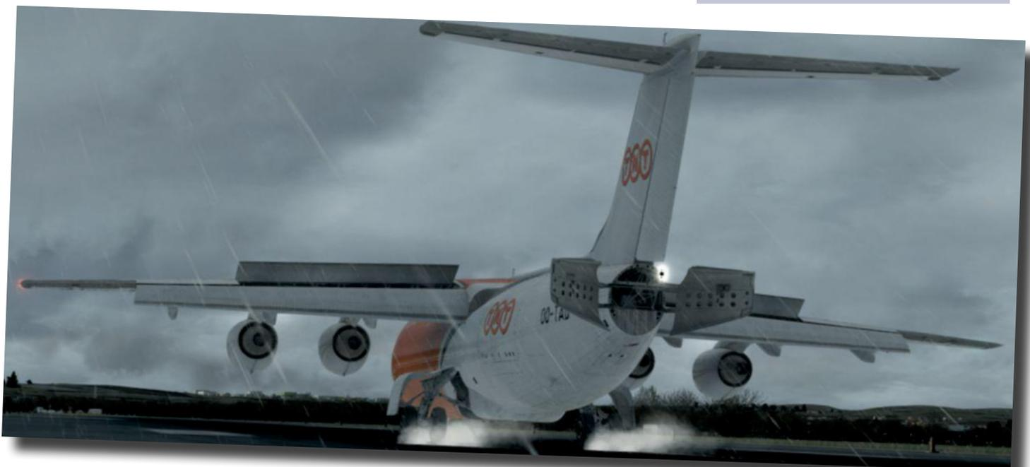
Ohne Schubumkehr geht es auch: Die BAe 146 wird effektiv mittels Störfächern gebremst.
