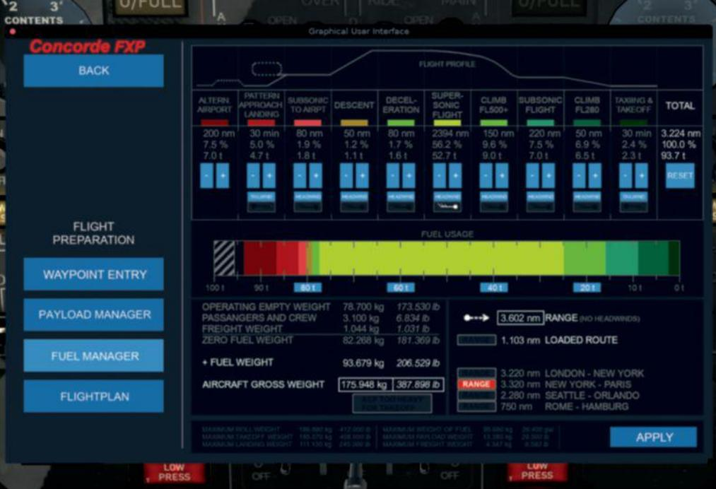
Der Treibstoffmanager des GUI mit dem vorberechneten Verbrauch.
